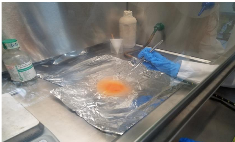
Figura 4.2. Deposición de solución CdS.
