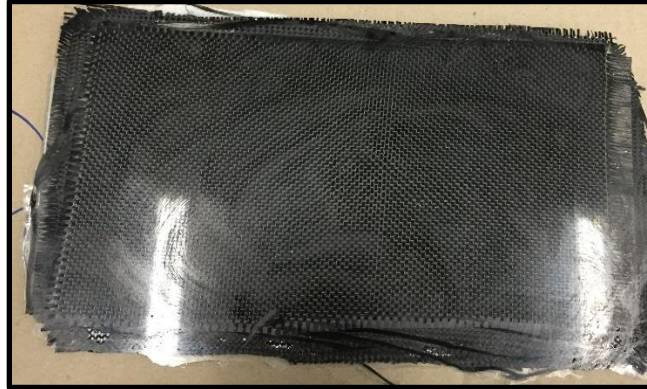
Figura 3.14. Acabado de laminado de fibra y resina epóxica.
