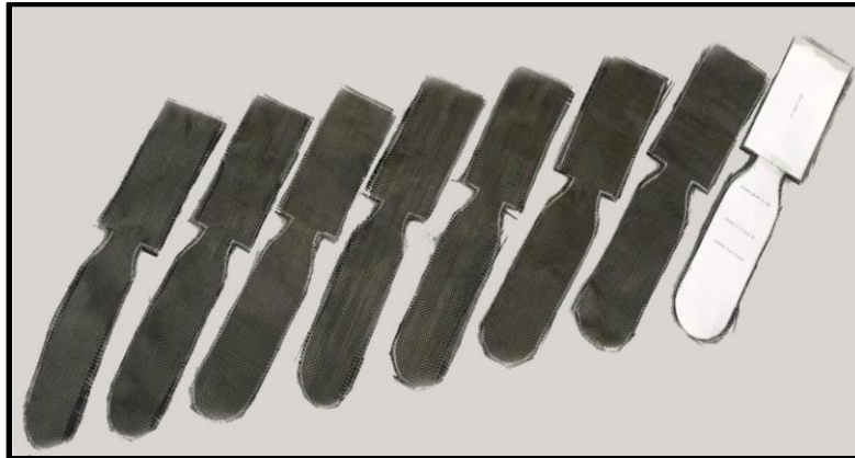
Figura 3.36. Fibra de carbono cortado a 0° y 45° previo a la fabricación del compuesto.
