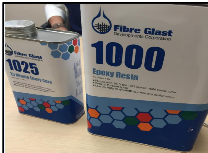
Figura 3.42. Resina epóxica system 1000 y catalizador 1025. (System 1000 Epoxy Resin, 2010)
