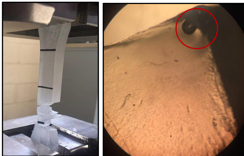
Figura 4.1. Muestra 5, modo de falla fuera de la zona calibrada en muestras de resina epóxica system 1000.
