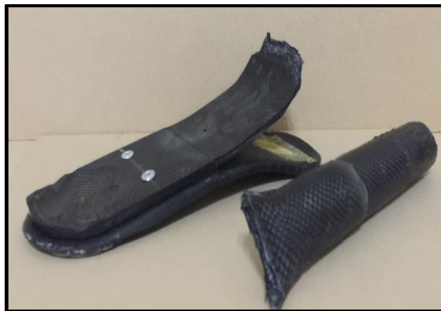
Figura 4.9. Aspecto general de la prótesis transtibial sometida a fatiga y compresión.
