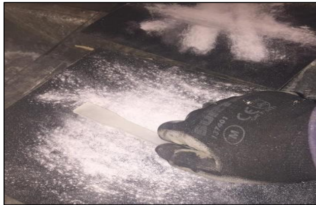
Figura 3.8. Rectificado de las muestras de resina epóxica y poliéster con lijas a diferentes grados de orientación.
