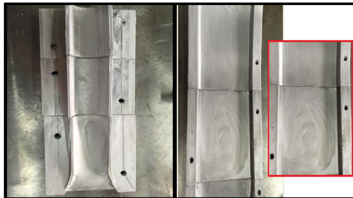
Figura 3.44. Aplicación de cera al molde en etapa de preparación.
