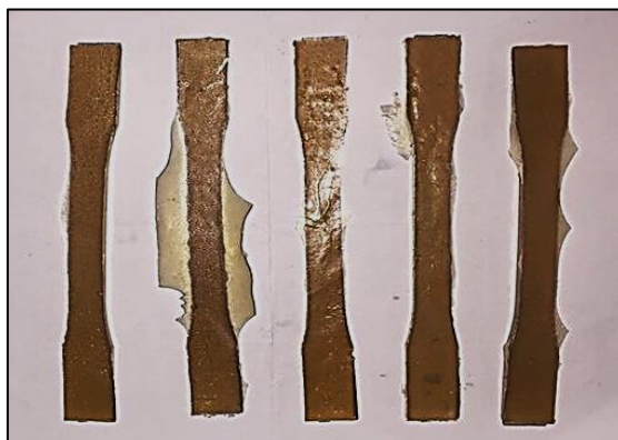
Figura 3.7. Muestras de resina antes de rectificado.
