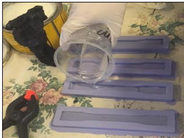
Figura 3.6. Mezcla vertida en moldes de silicón para muestras tipo I.
