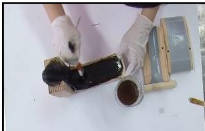
Figura 3.37. Impregnación manual (hand lay – up) de la fibra.
