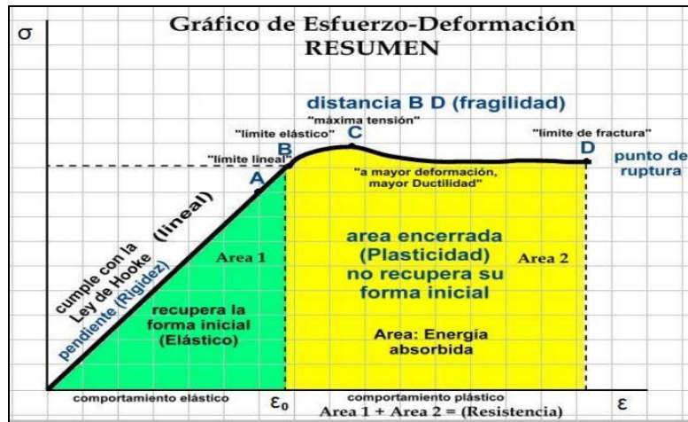
Figura 2.40. Esfuerzo Vs deformación, representación del comportamiento elástico y plástico. (Cecilia Ariagno, 2014)
