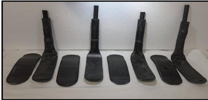
Figura 3.59. Prototipos de prótesis con laminados de 20 capas.
