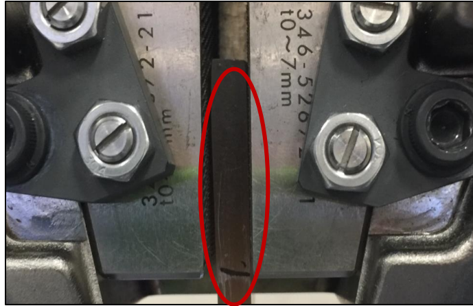
Figura 4.3. Mala sujeción en área de mordaza superior en muestra 2, debido a superficie cóncava.
