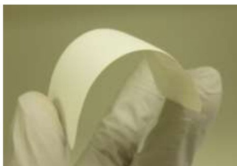
Figura 22. Placa cromatográfica fabricada en plástico polimérico utilizando \mu Celulosa.
