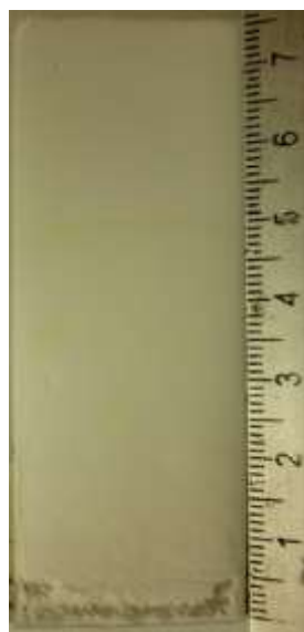
Figura 23. Cromatograma desarrollado en sistema 4:1:1 fabricado con Si gel 60 G sin agentes aglutinantes adicionales.
