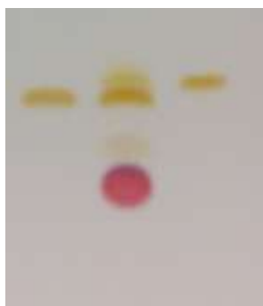
Figura 21. Cromatograma desarrollado con el sistema final 7:2:3. De izquierda a derecha se muestra al ácido kaínico, una mezcla de 4 aminoácidos (L-lisina, prolina, ácido kaínico y AD) y AD.
