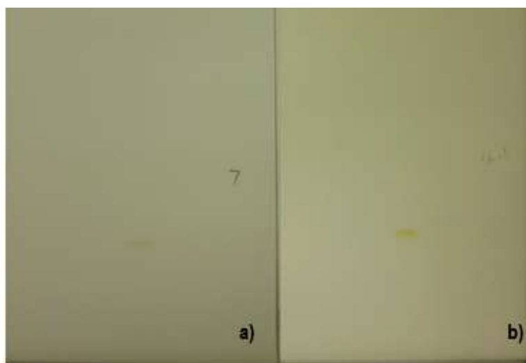
Figura 25. Cromatograma desarrollado con una placa cromatográfica comercial y un sistema Alcohol:ácido orgánico:agua (7:2:3). Se muestra una comparación entre una concentración de 50 ppm y 100 ppm.
