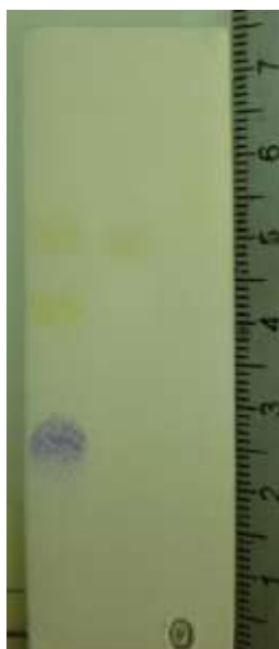
Figura 12. Cromatograma de \mu celulosa desarrollado en el sistema Sol-C4. De Izquierda a derecha, mezcla con 3 aminoácidos (L-lisina, prolina y ácido kaínico), ácido kaínico y ácido domoico.
