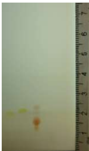
Figura 13. Cromatograma comercial Si 60 desarrollado en un sistema Sol-S3. De izquierda a derecha, prolina, AD y mezcla de 4 aminoácidos (L-lisina, prolina, ácido kaínico y AD).
