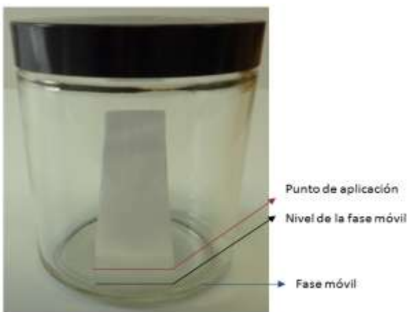
Figura 7. Cámara de desarrollo para las placas cromatográficas. Se muestran la distancia entre el nivel de la fase móvil y el punto de aplicación.
