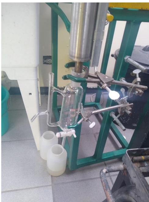
Figura 13. Integración del decantador al sistema de extracción.
