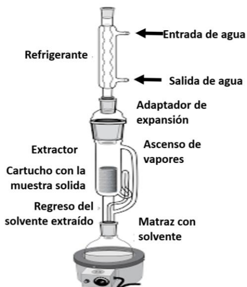
Figura 4. Diagrama del proceso del método de extracción por solvente. Adaptado de Rassem, H. H., Nour, A. H., y Yunus, R. M. (2016).
