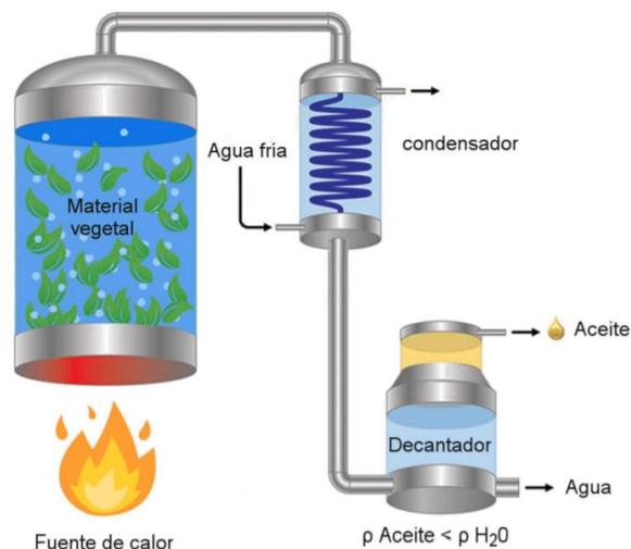
Figura 5. Diagrama de proceso del método de hidrodestilación. Adaptado de Dangkulwanich, M. y Charaslertrangi, T. (2020).
