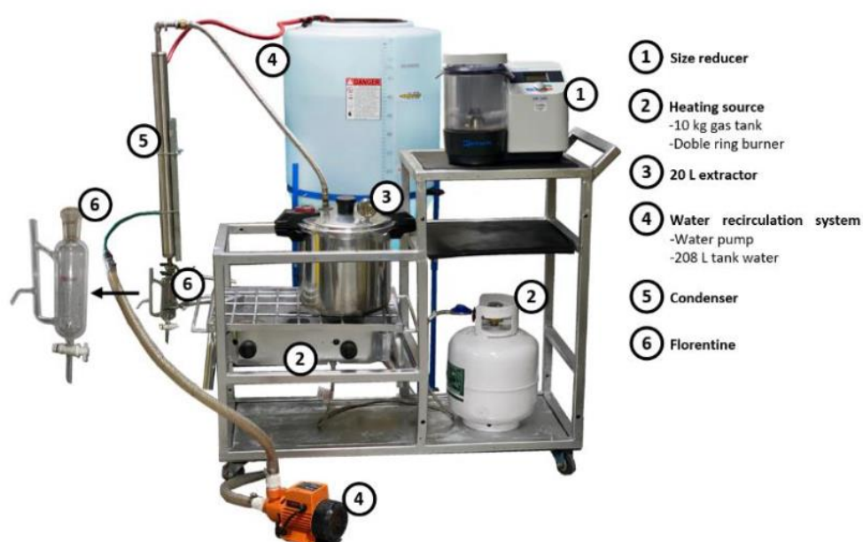
Figura 15. Sistema extractor de aceites esenciales de cítricos.
