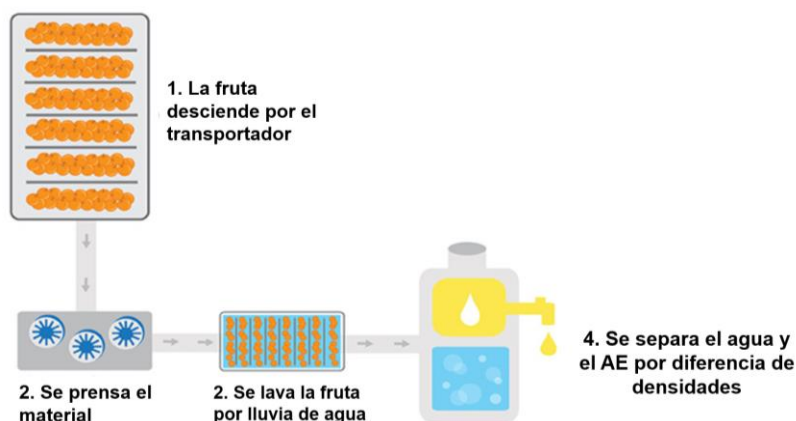
Figura 8. Representación gráfica del método de prensado en frío. Modificado de Brada P. et al, 2021.
