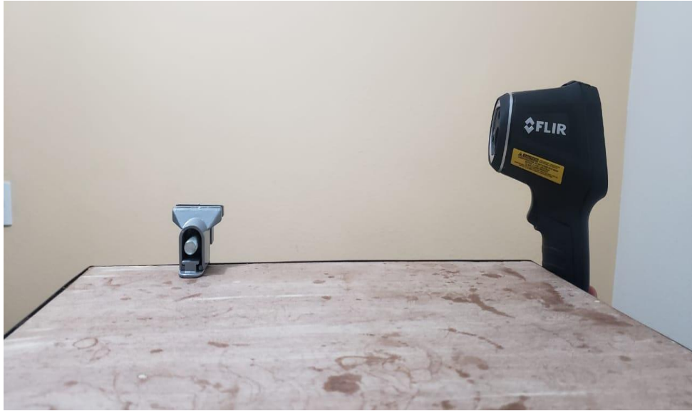
Figura 12: Distancia de 10 cm con la muestra y una sensibilidad de 0.1 °.
