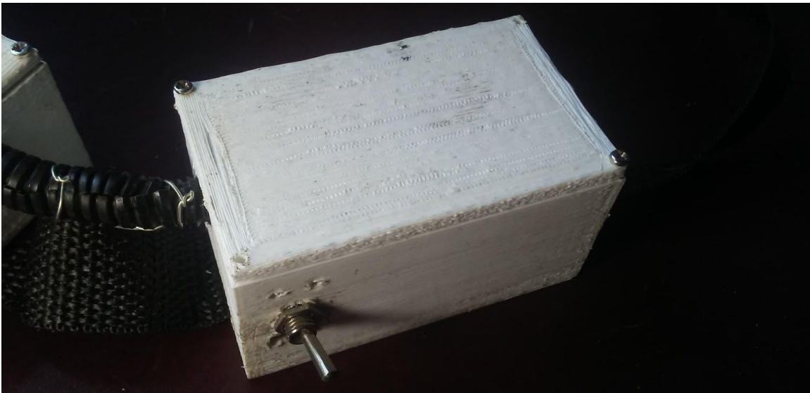
Figura 17. Contenedor de baterías armado
