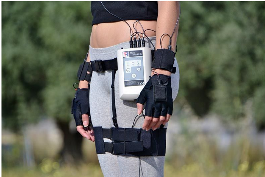
Figura 2. Unidad de control Tech MCS.
