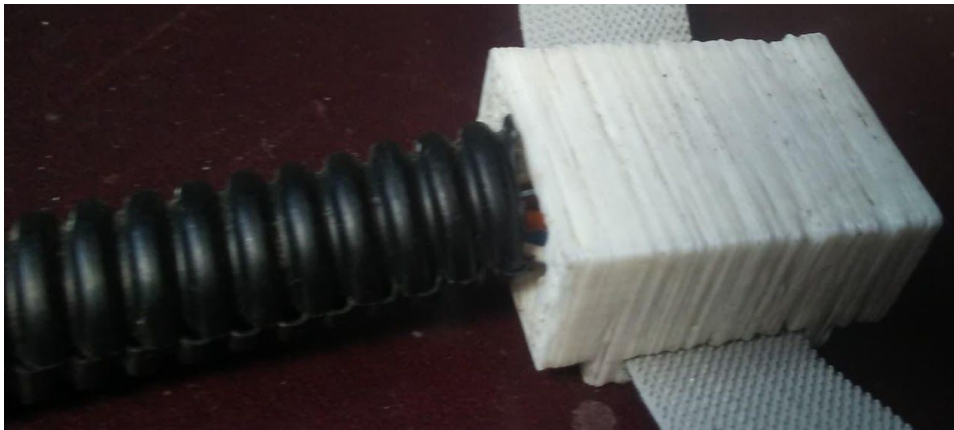
Figura 26. Contenedor de sensor armado.
