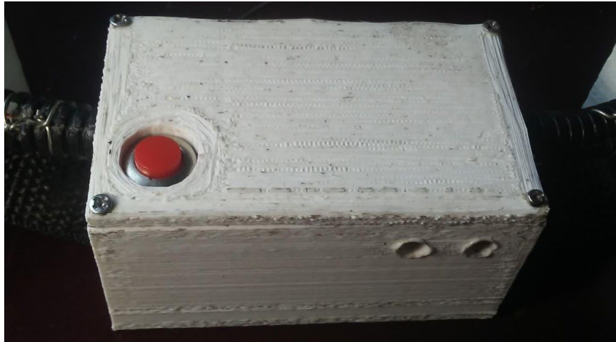
Figura 20. Contenedor de unidad de control armado.
