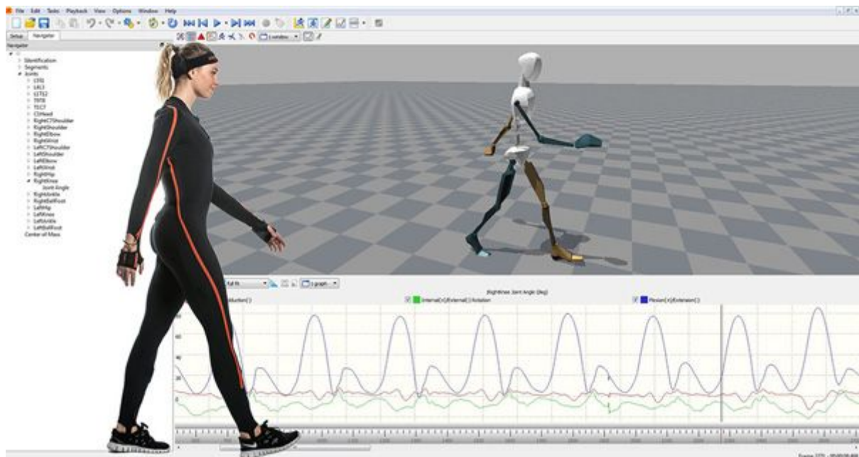
Figura 4. Traje de sensores inerciales MVN Biomech con 17 sensores inerciales.
