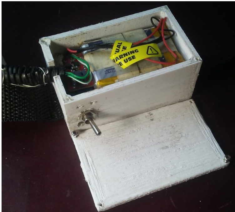
Figura 19. Contenedor de baterías expuesto.
