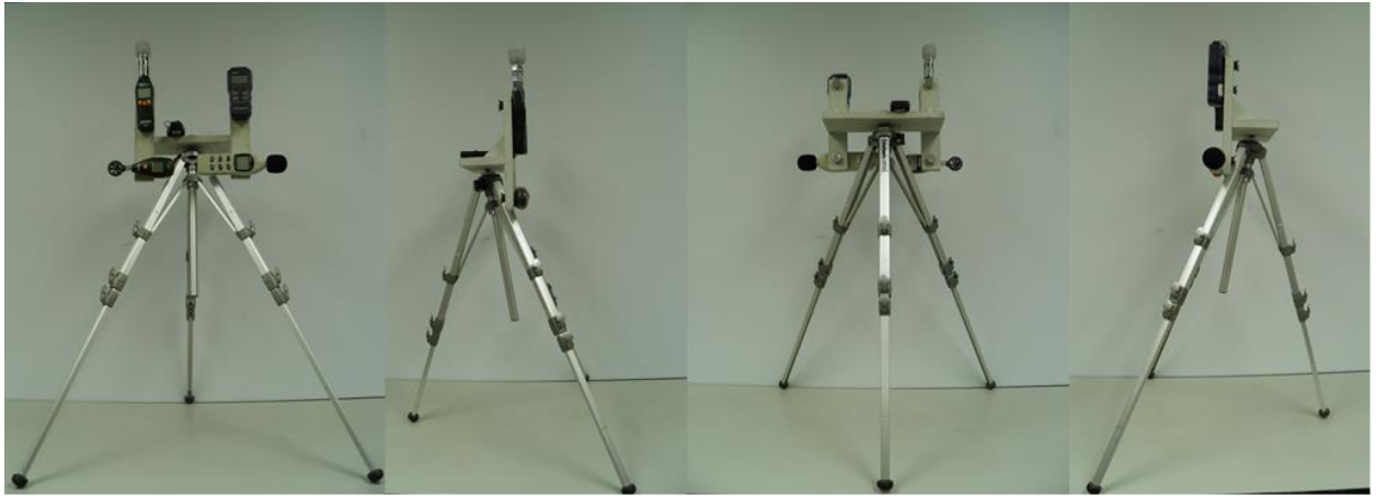
Fuente: Elaboración propia, imágenes capturadas en sitio Anexo F16.- Montaje de los instrumentos en soporte trípode para estudio en campo.
