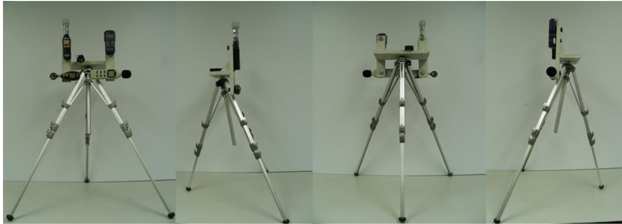
Fuente: Elaboración propia, imágenes capturadas en sitio Figura 30.- Montaje de los instrumentos en soporte trípode para estudio en campo.
