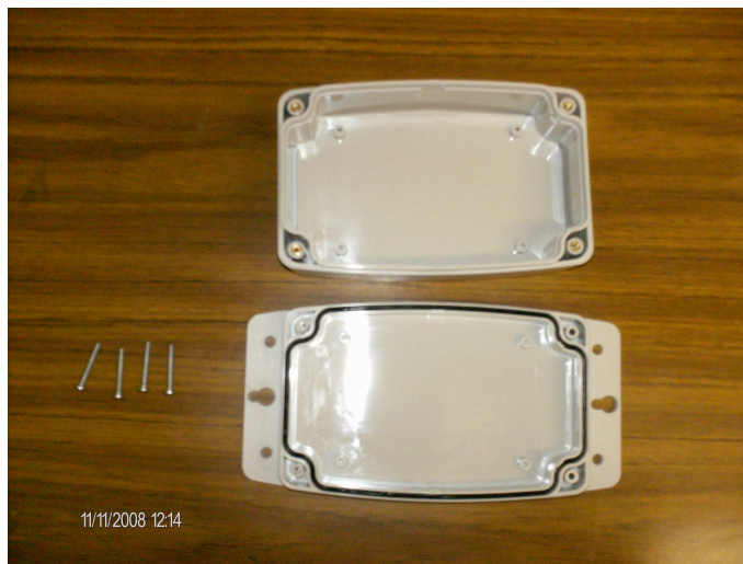
Figura 3.17: Contenedor o housing utilizado para resguardar los módulos
