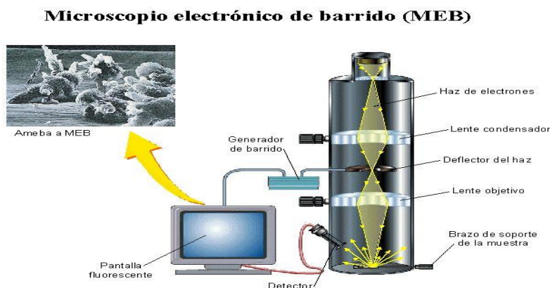
Figura 15. Componentes de la óptica del MEB convencional. (Fuente: http://almez.pntic.mec.es/~jrem0000/dpbg/1bch/tema1/micros-barr.JPG )
