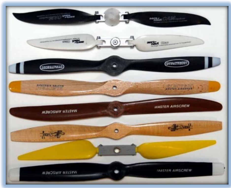
Fig. 2.13 Ejemplos de hélices fabricadas con madera, fibra de carbono y nylon.
