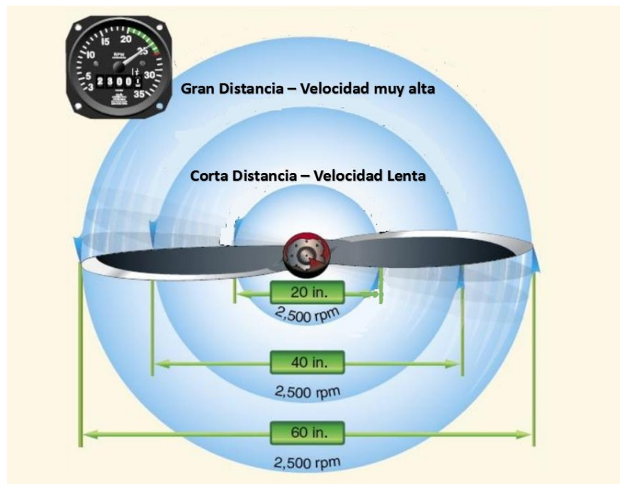
Fig. 2.14 Velocidades de hélices a distintos diámetro. [27]
