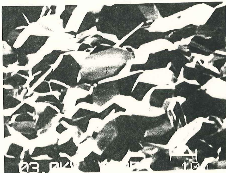
Micrografía 10: CdTe(600°C-700°C), P=55 Torr, 1000X, 3 kV, 1 nA.
