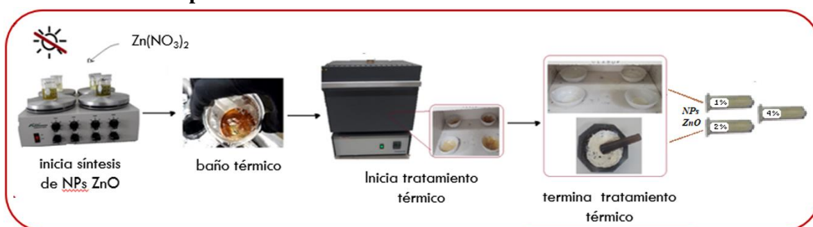
Figura 14. Proceso para la obtención de las nanopartículas de ZnO.
