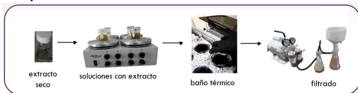
Figura 13. Proceso para la obtención de soluciones con extracto de Capsicum annuum Anaheim .
