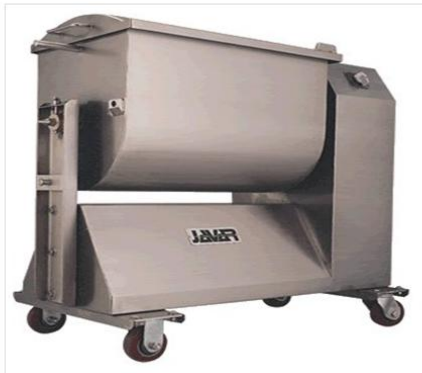
Figura 3. Mezcladora para incorporación de ingredientes y amasado.
