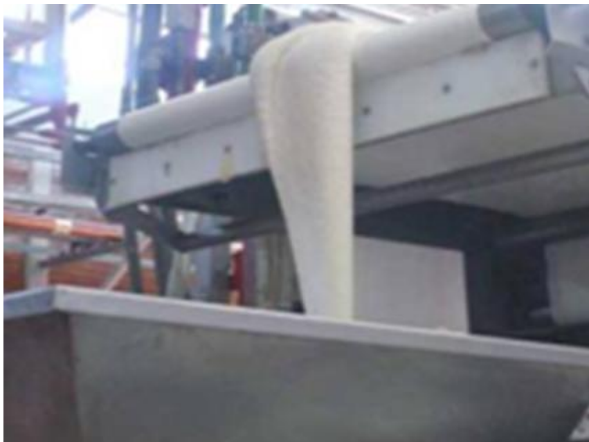
Figura 4. Transferencia de la masa a la tolva de la divisora.
