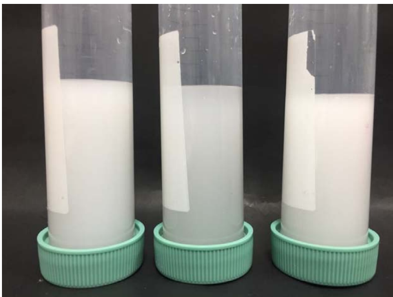
Figura 7 Formulación en fresco de NPs. Preparadas con IPA, MeOAc, EtOAc respectivamente. 1% PVA, 2 % de Tween en FA y 100 mg de sal lipídica en FI se mantuvieron constantes.
