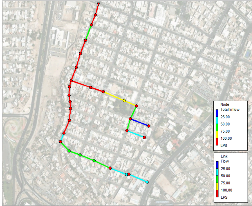
Figura 18. Instante de saturación total (100 % de llenado) en tramos críticos de la red pluvial simulada T_r=25 años Fuente: Elaboración propia.
