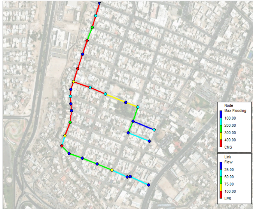
Figura 26. Instante de saturación total (100 % de llenado) en tramos críticos de la red pluvial simulada con SUDS Tr= 50 años Fuente: Elaboración propia.
