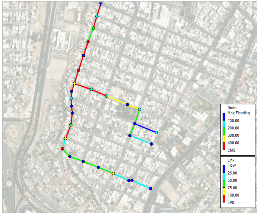
Figura 24. Instante de saturación total (100 % de llenado) en tramos críticos de la red pluvial simulada con SUDS Tr=25 años Fuente: Elaboración propia.
