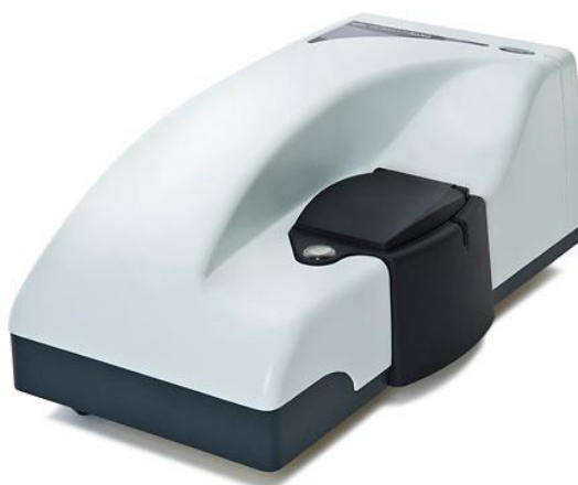
Figura 6.- Equipo ZetaSizer Nano-ZS
