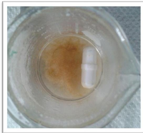
Figura 5. Precipitación de proteínas por medio de sulfato de amonio  $(\text{NH}_4)_2\text{SO}_4$ , en donde se aprecia la conglomeración de proteínas ocasionado por el fenómeno de salting-in y salting-out
