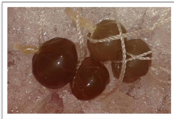
Figura 6. Muestra obtenida de la precipitación salina colocada en membrana para diálisis con un MWCO de 12 000 – 14 000 Daltons
