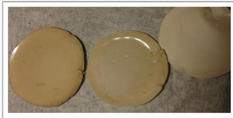
Figura 8. Disminución gradual de pigmentos presentes en la muestra. Se observa que la filtración al vacío elimina moléculas que puedan interferir en los pasos siguientes de la purificación enzimática
