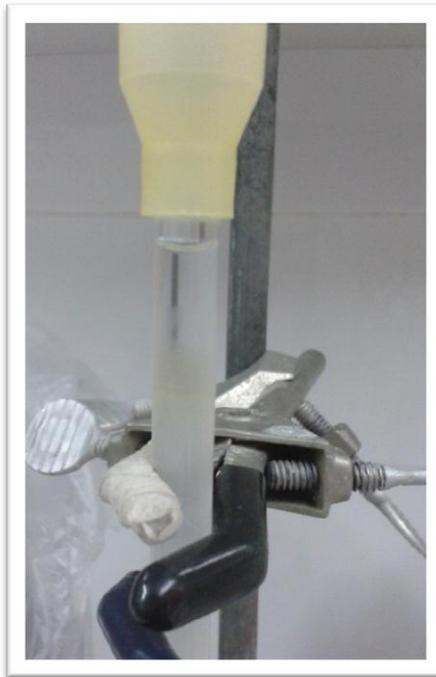
Figura 9. Muestra cargada en la columna de intercambio iónico DEAE-C (DE-52)
