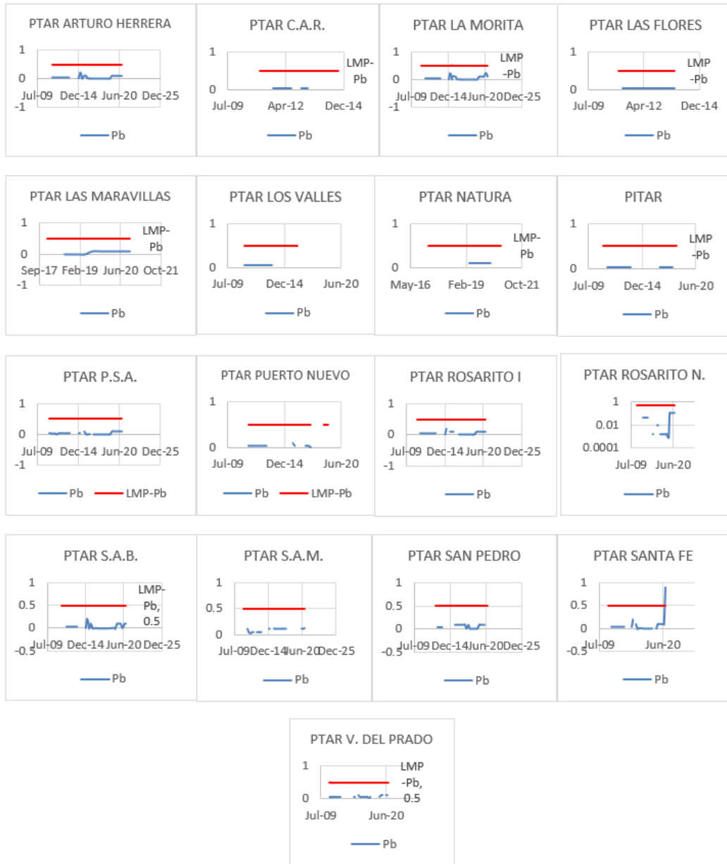
Figura 93 Concentraciones de Plomo para las PTAR analizadas
