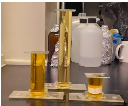
Figura 3. Columnas de plexiglass correspondientes a tres volúmenes, de izquierda a derecha: 50, 100 y 25 mL.
