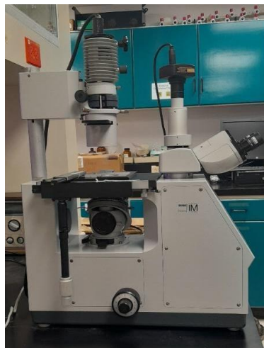
Figura 2. Microscopio invertido ZEISS IM.
