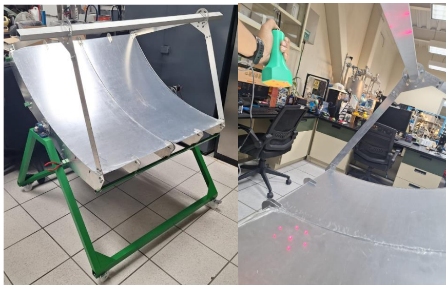
Figura 105. Producto final y pruebas ópticas en laboratorio.
