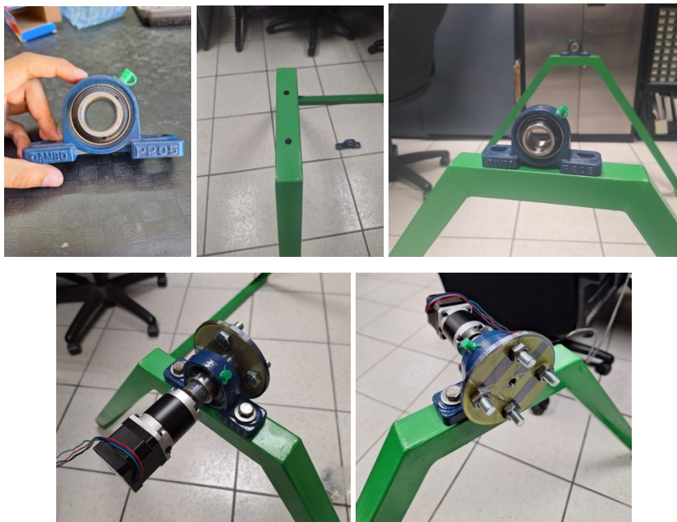
Figura 99. Ensamble de base estructural, base de motor, chumacera buje y motor a pasos del prototipo CCP-TEG.
