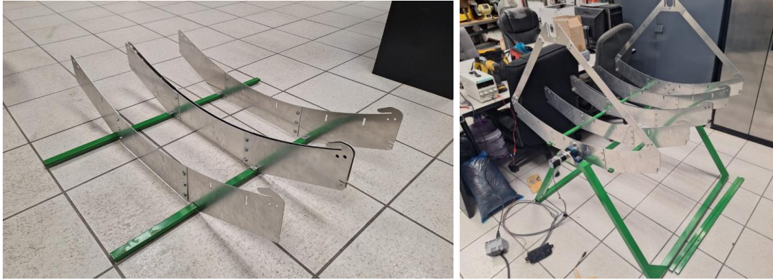
Figura 101. Ensamble del costillar y elementos laterales del prototipo CCP-TEG.
