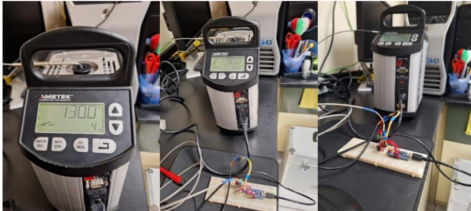
Figura 107. Calibración de sensores de temperatura en dispositivo AMETEK.
