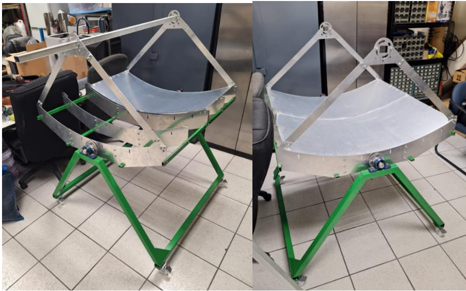
Figura 102. Ensamble del lamina reflectiva y absorbedor del prototipo CCP-TEG.
