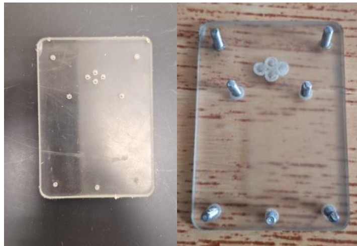
Figura 103. Elemento adicional para doblar clips de sujeción de Peltier en el absorbedor del prototipo CCP-TEG.
