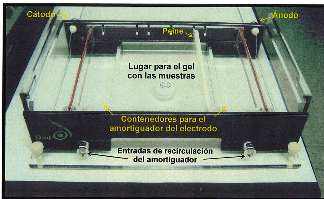
Fotografía 2. Celda utilizada para las corridas electroforéticas. Se observan los electrodos, la zona en donde se deposita el gel de almidón con las muestras, y los contenedores para el amortiguador del electrodo.
