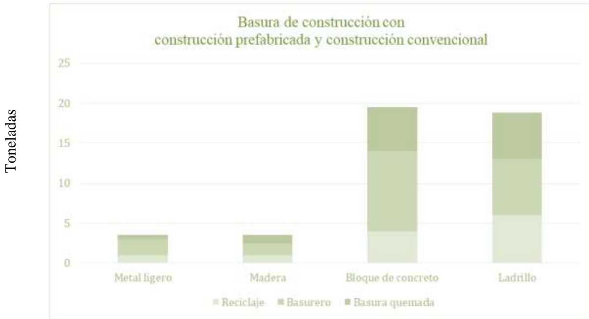
Figura 7. Basura de construcción en construcción convencional.
