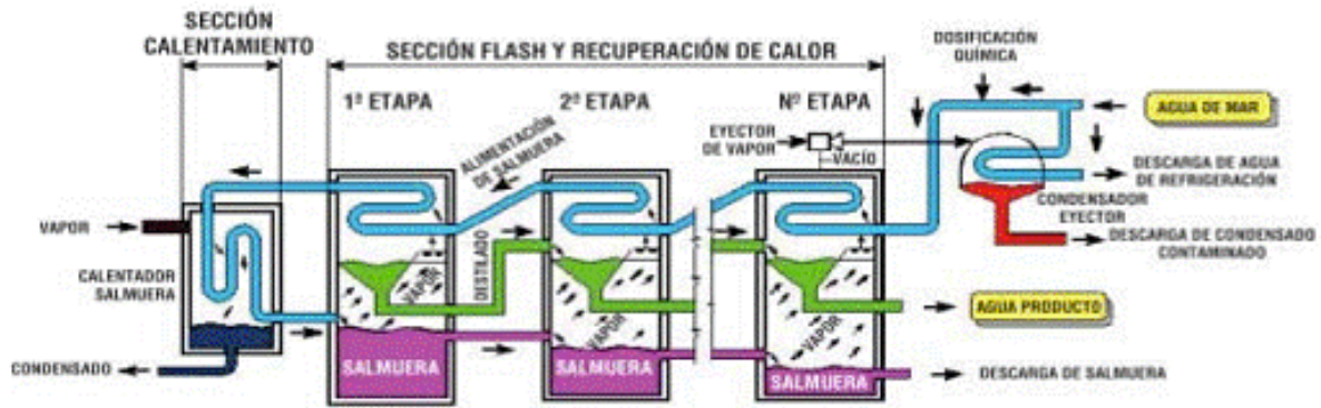
Figura 1 Diagrama de una planta de desalación por efecto flash (Moreno, 2011)
