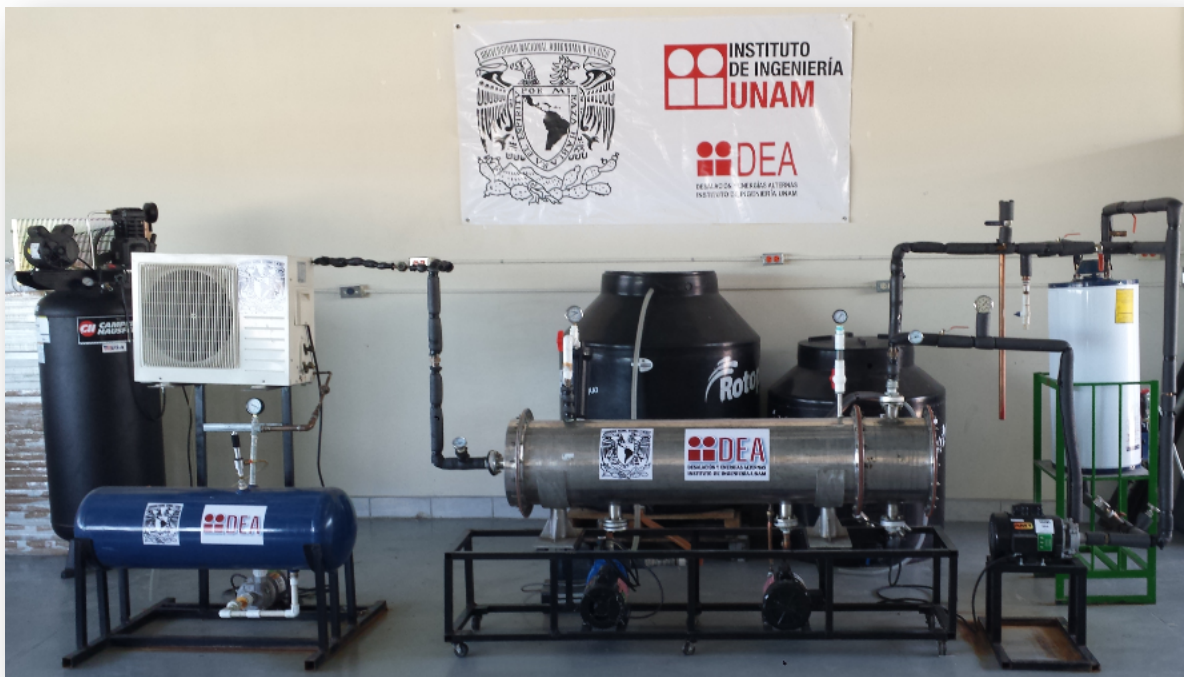
Figura 5 Equipo MED-LE terminado en la primera etapa. (Hernández 2014)
