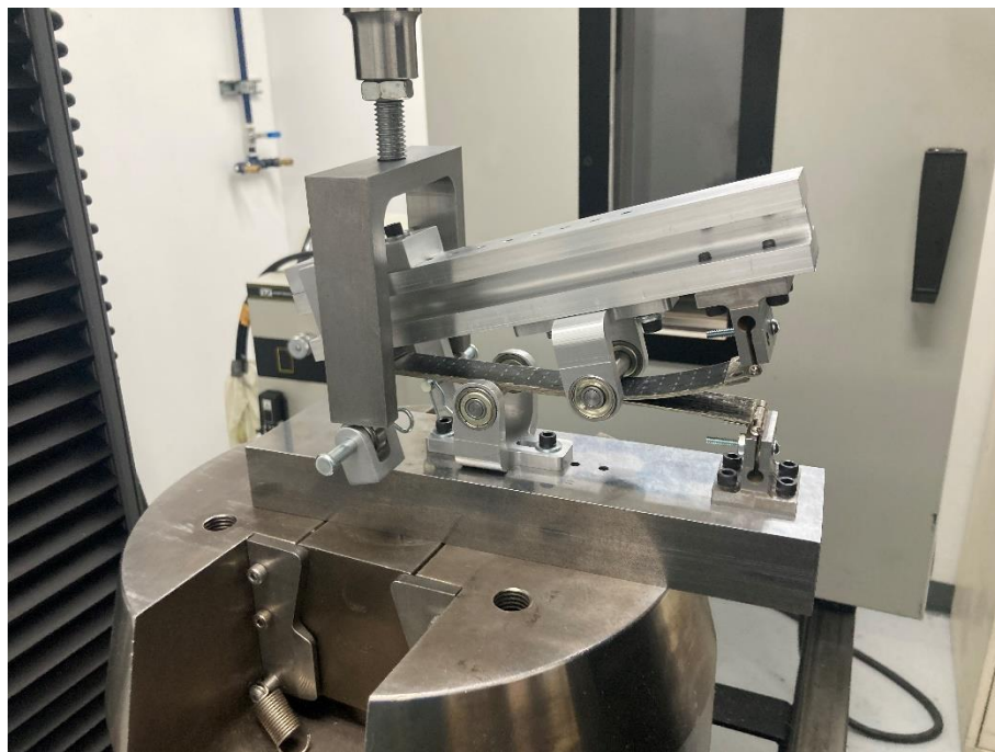
Figura 5.26. Ejemplo de una prueba de fractura por modo mixto en curso.
