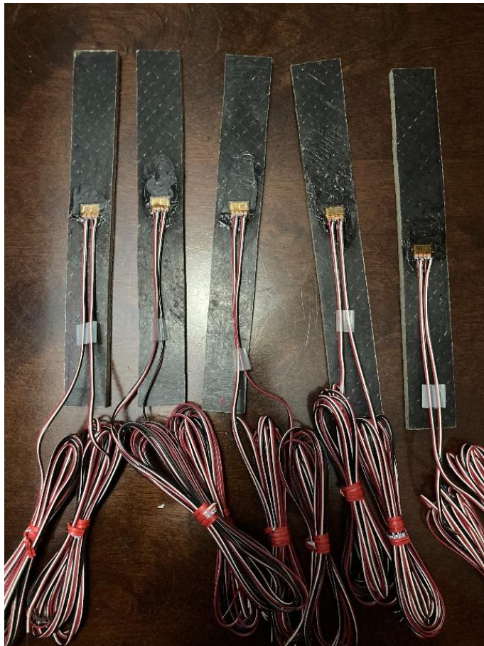
Figura 5.14. Especímenes de prueba ASTM D3518 con galgas extensiométricas instaladas.
