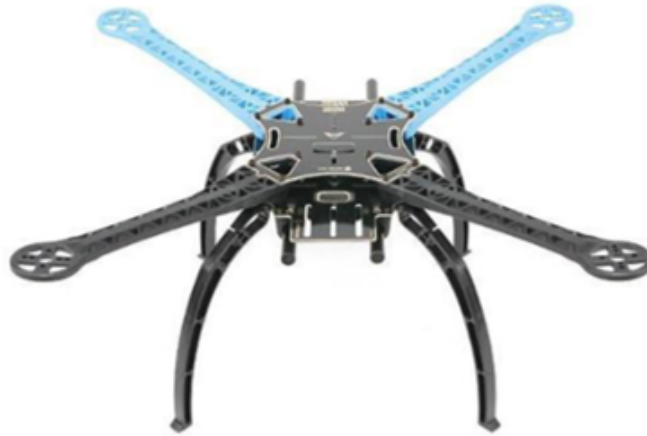
Figura 4.1: Armazón de cuadricóptero de fibra de vidrio S500[20].
