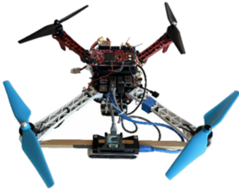
Figura 2.4: Cuadricóptero con sensores y cámara montada en barra fija, en configuración + [22].
