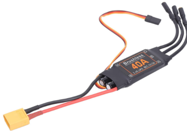
Figura 4.3: Controlador electrónico de velocidad, modelo 40 A.
