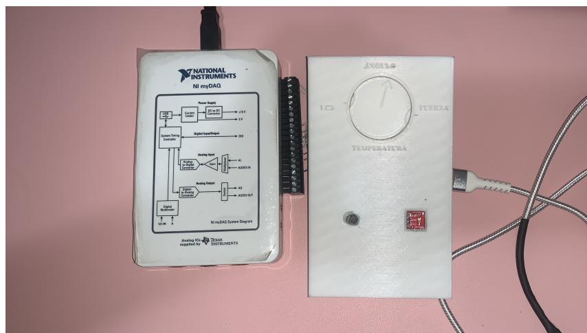
Figure 4.1: Prototipo conectado al NI myDAQ para la toma de mediciones.
