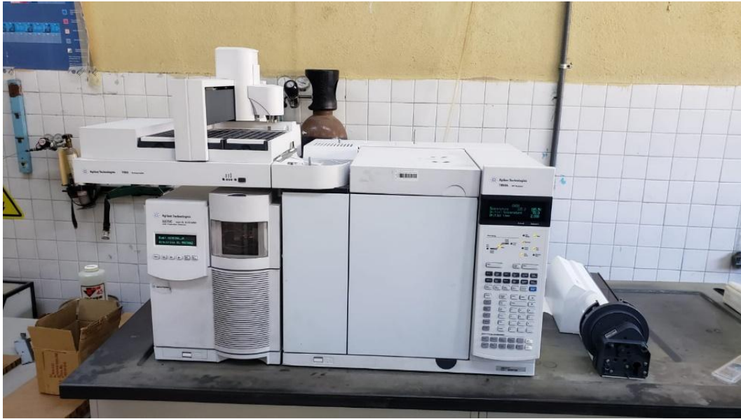
Figura 14. Equipo de CG-EM marca Agilent 7890A acoplado a un detector de Masas de Agilent Technologies 5975C equipado con una columna capilar HP-5MS (ITT Tijuana).
