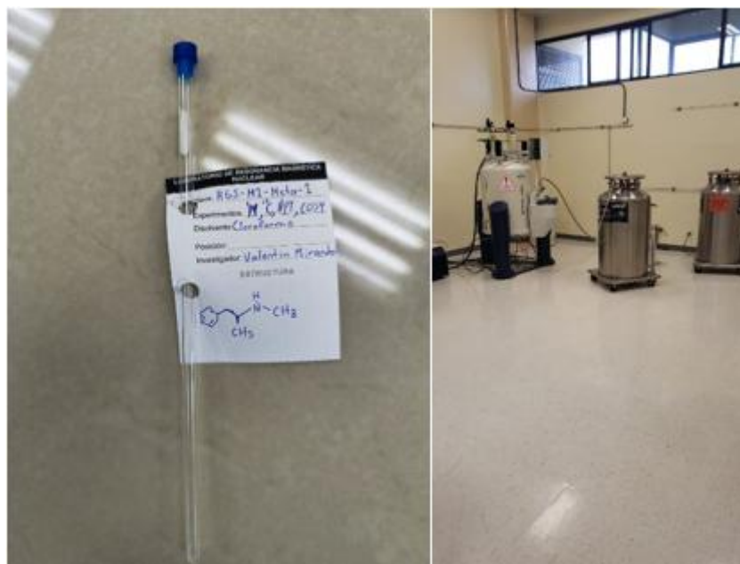
Figura 13. Tubo de RMN y Bruker Avance III de 400 MHz (ITT).
