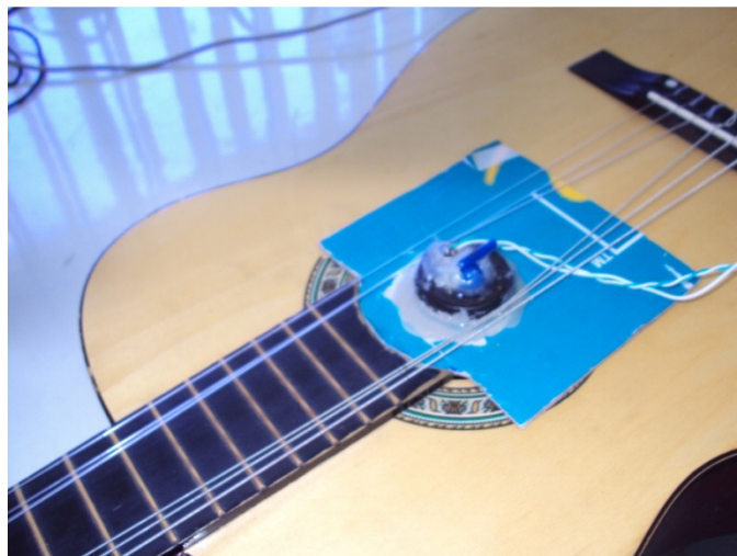
Figura 3.7 Colocación del sensor para pruebas en cajas acústicas.
