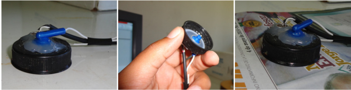
Figura 3.8 Colocación de sensor sobre superficie laminada (izquierda), hacia el espacio libre (centro), y sobre papel periódico (derecha).
