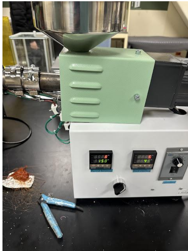
Fig. 25. Extrusora temperatura fijada 150.
