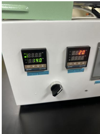
Fig. 43. Cambios temperatura extrusión graduales.
