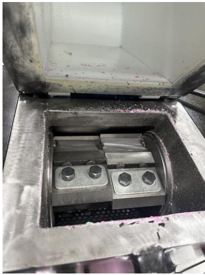
Figura 32 y 33. Navajas antes y después de la limpieza.
