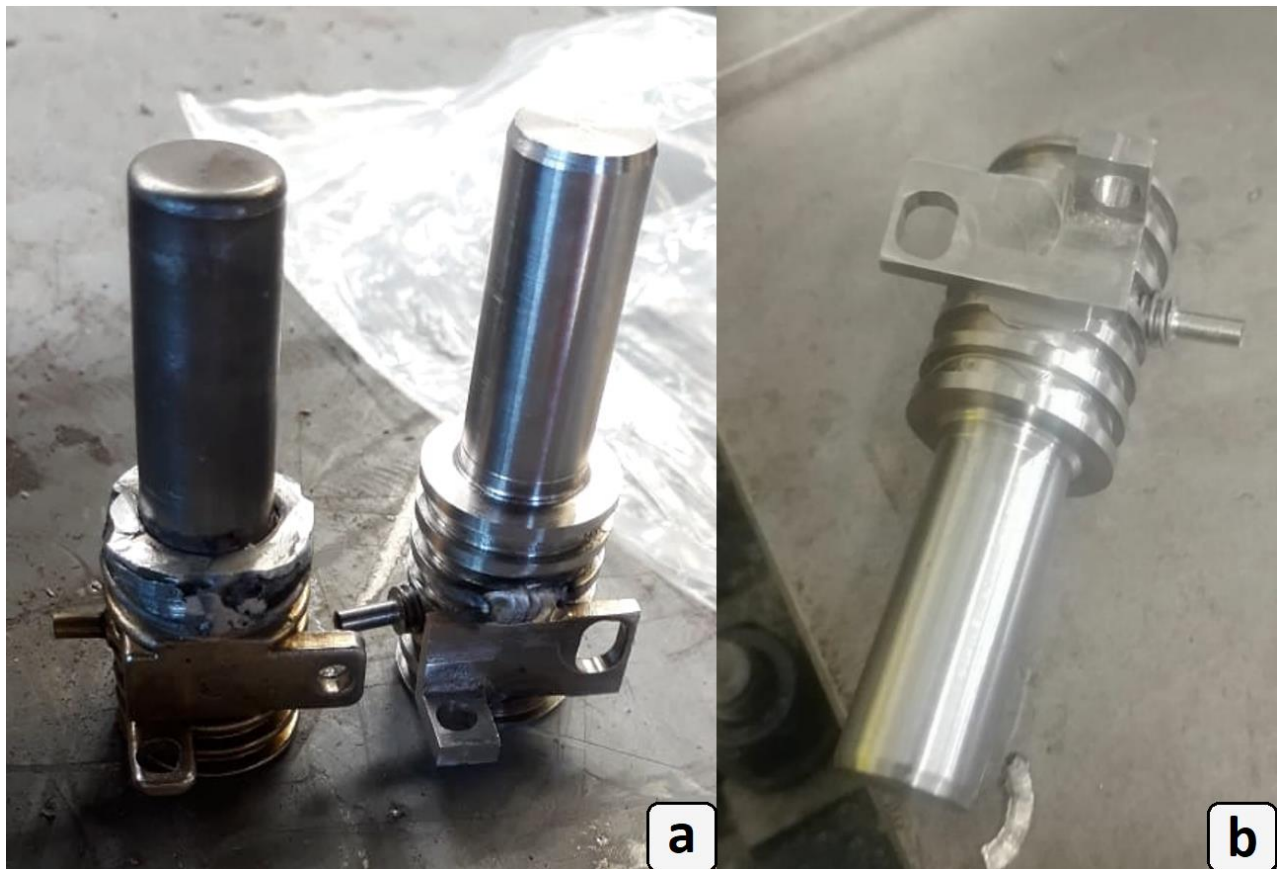
Figura 4.5. Maquinado del calentador de acero inoxidable para temperaturas superior a los 700 °C.
