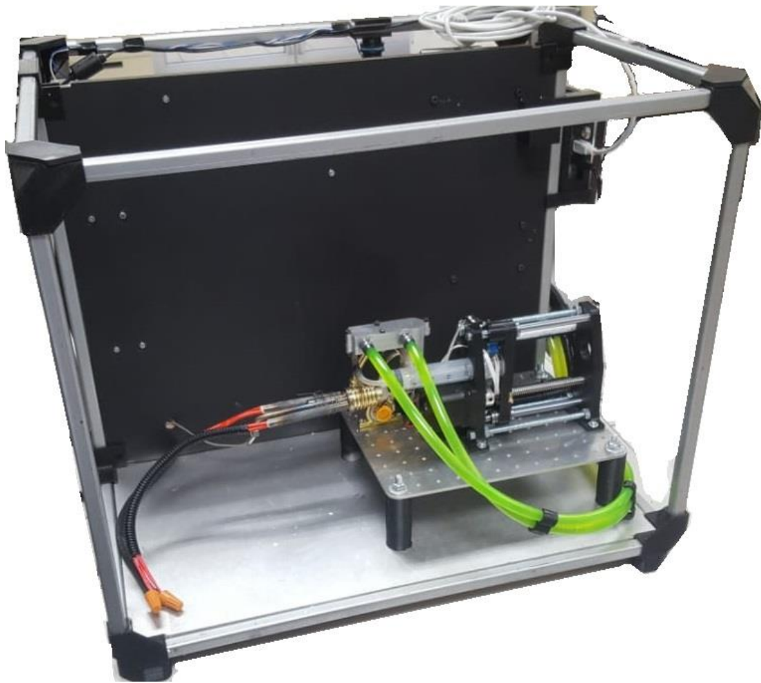
Figura 4.10. Nano-banco de prueba del motor Stirling controlado por volumen muerto.
