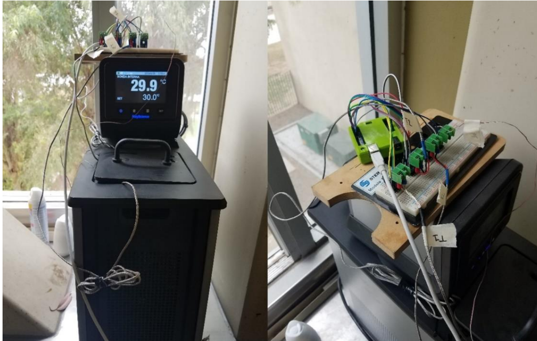
Figura 4.17. Implementación del equipo Polyscience para la calibración de los sensores de temperatura de la nano-planta.
