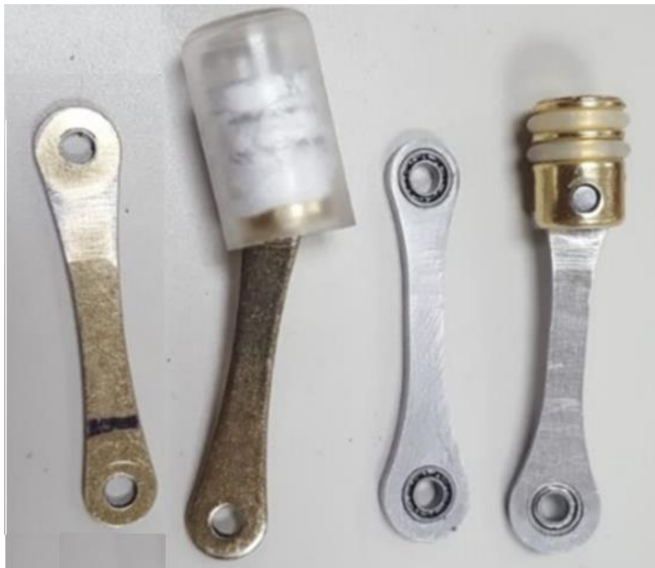
Figura 4.3. Diseño y construcción de las bielas con rodamientos para minimizar la fricción.
