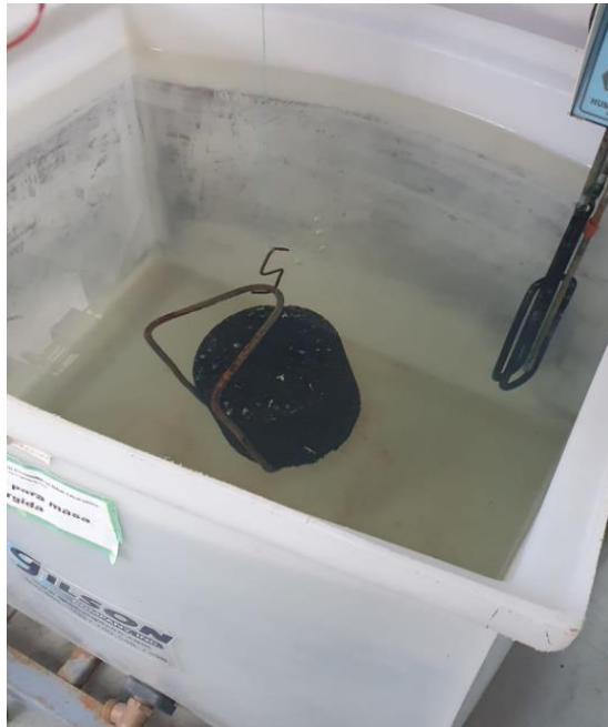
Imagen 29. Mezcla asfáltica sumergida
