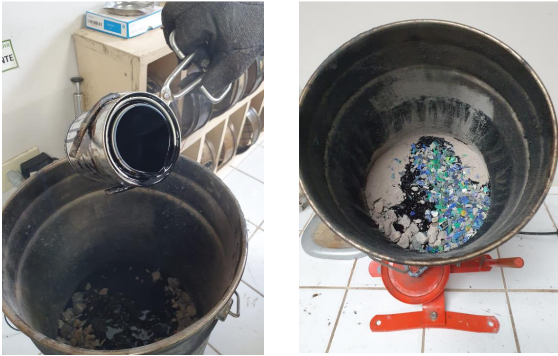
Imagen 24. Preparación de mezcla asfáltica.
