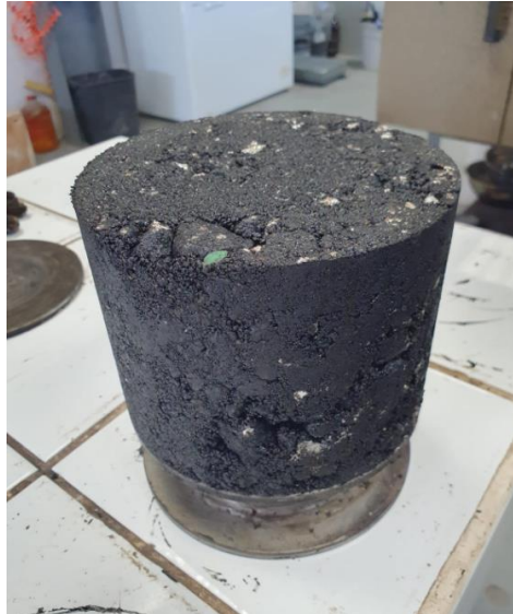
Imagen 26. Mezcla asfáltica con HDPE compactada adecuadamente
