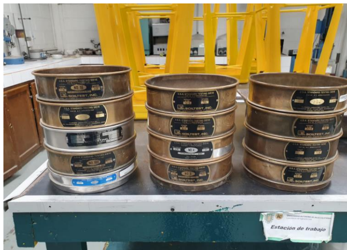
Imagen 14. Mallas de cribado.
