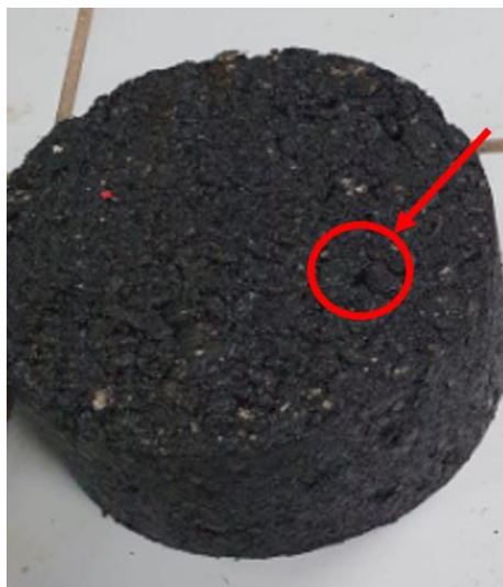
Imagen 32. Vacíos en pastillas de mezclas asfálticas.
