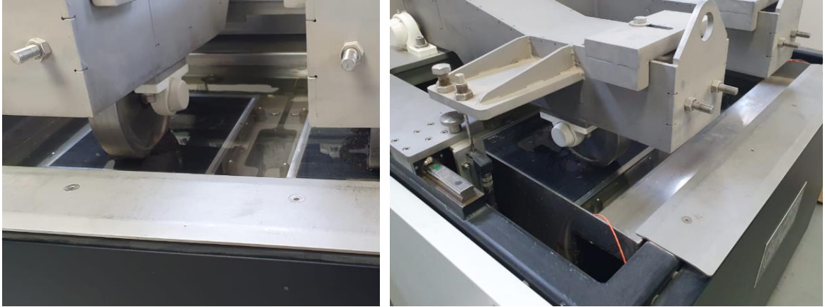
Imagen 43. Funcionamiento de Rueda de Hamburgo.
