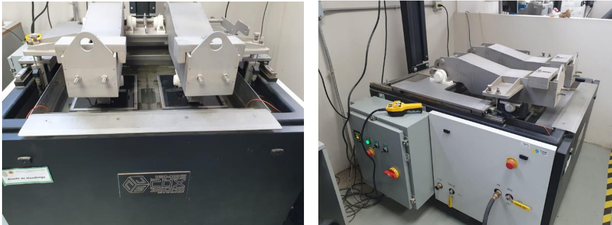
Imagen 35. Equipo de la Rueda Cargada de Hamburgo
