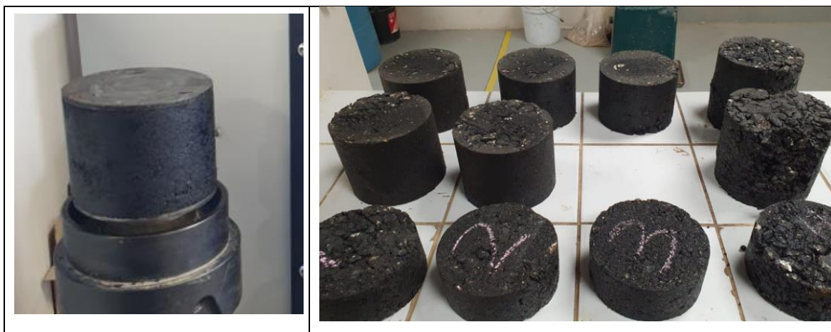
Imagen 41. Mezclas asfálticas compactada adecuadamente.
