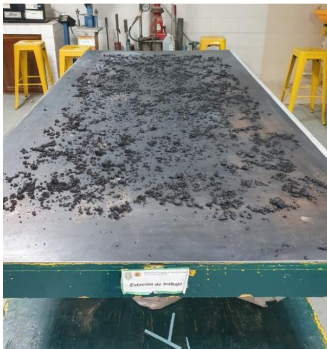
Imagen 30. Mezcla asfáltica sin compactar
