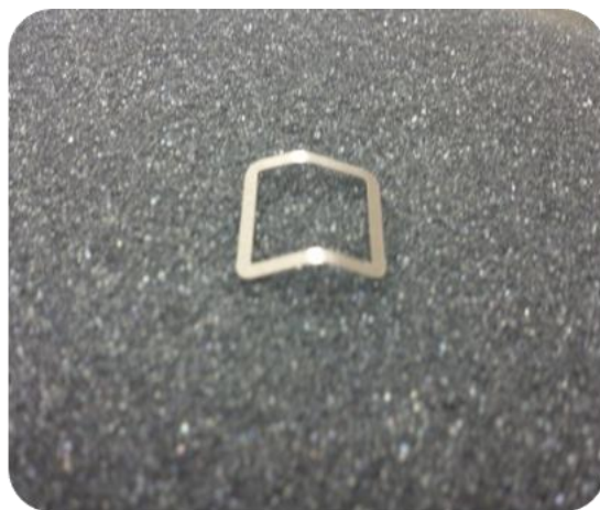
“Figura 28.- Soldadura Dañada”
