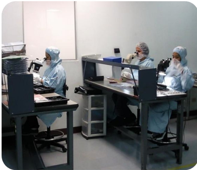
Figura 10.- Área de inspección de soldadura. Fuente: Elaboración propia a partir de datos del departamento 57440 TO.
