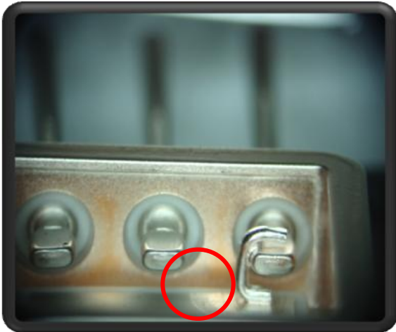
“Fig. 26.- Porosidad Perno Conector – Perno Anillo”.
