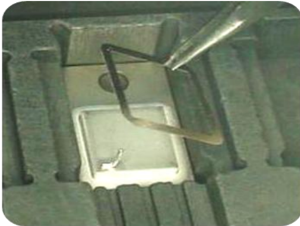
“Figura 25.- Etapa de ensamble: Posicionamiento de Soldadura”.
