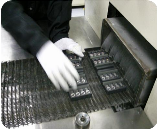
Fig. 8 Carga de Material en Horno.
