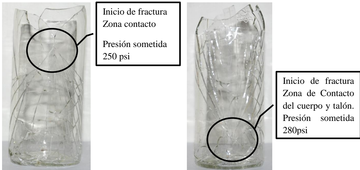
Figura 3.10 Imágenes de espécimen experimentación presión hidrostática
