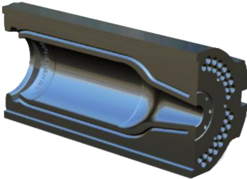
Figura 2.2 Moldura de un envase de vidrio
