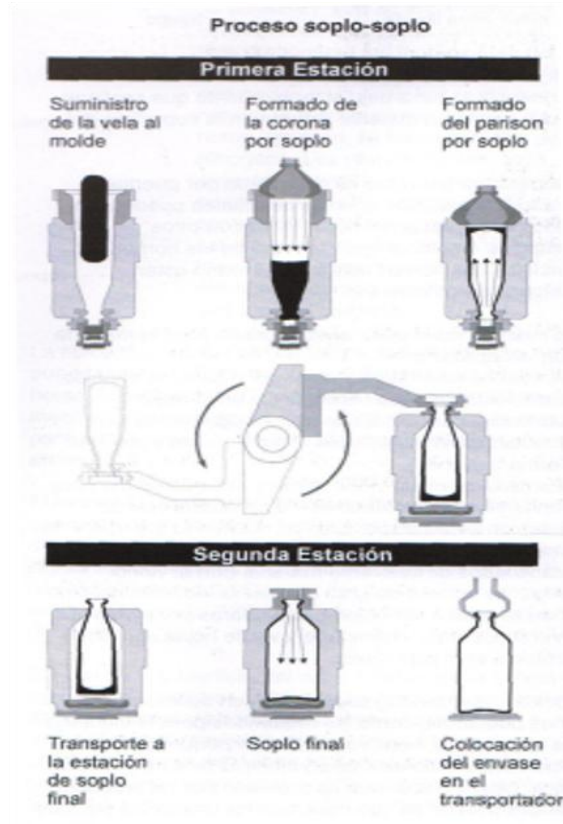
Figura 1.3 Proceso soplo-soplo
