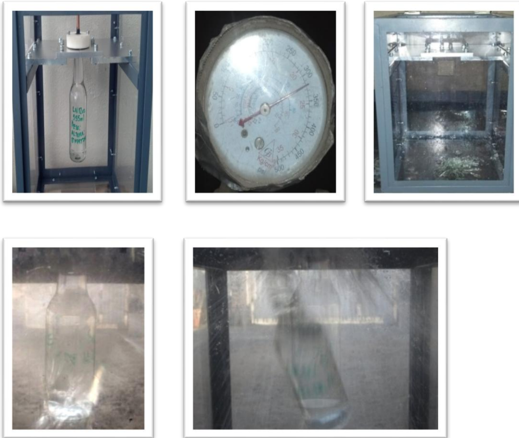
Figura 3.8 Imágenes durante experimentación presión hidrostática
