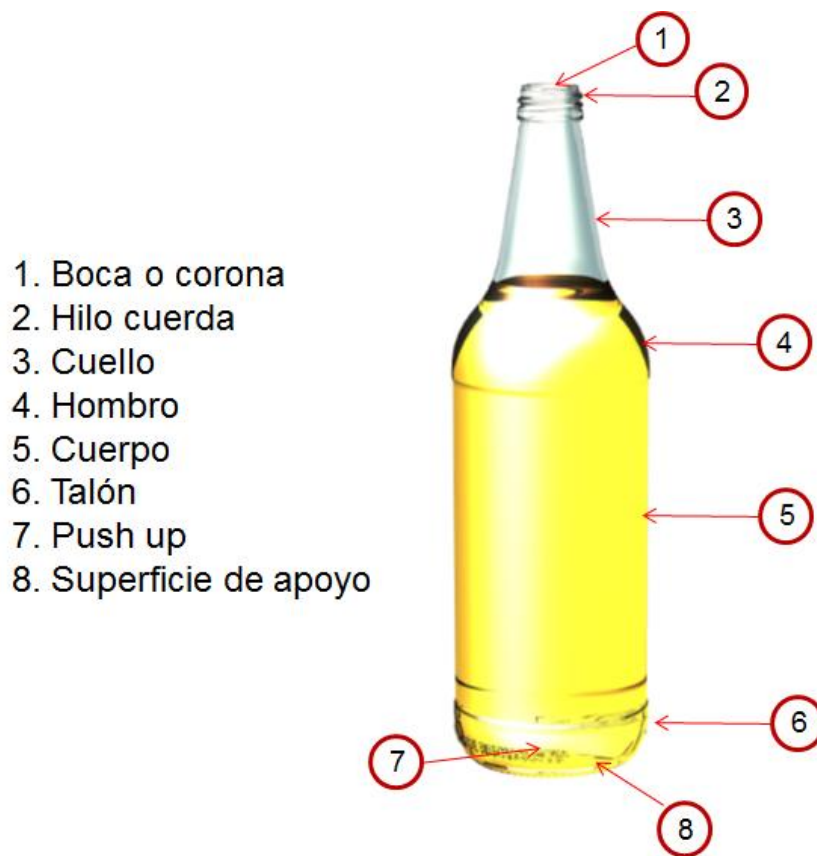
Figura 2.1 Partes de un envase de vidrio
