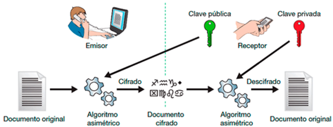
Figura 8: Funcionamiento de clave asimétrica, tomado de [39].
