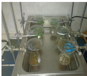
Figura 25. Digestión en termo baño.
