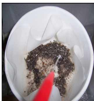
Figura 23. Lavado de la muestra con Agua destilada caliente
