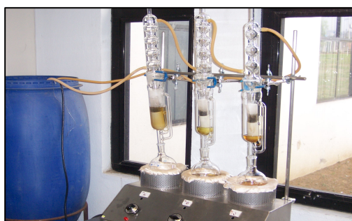
Figura 16. Parrilla y sistema de reflujo Soxhlet.
