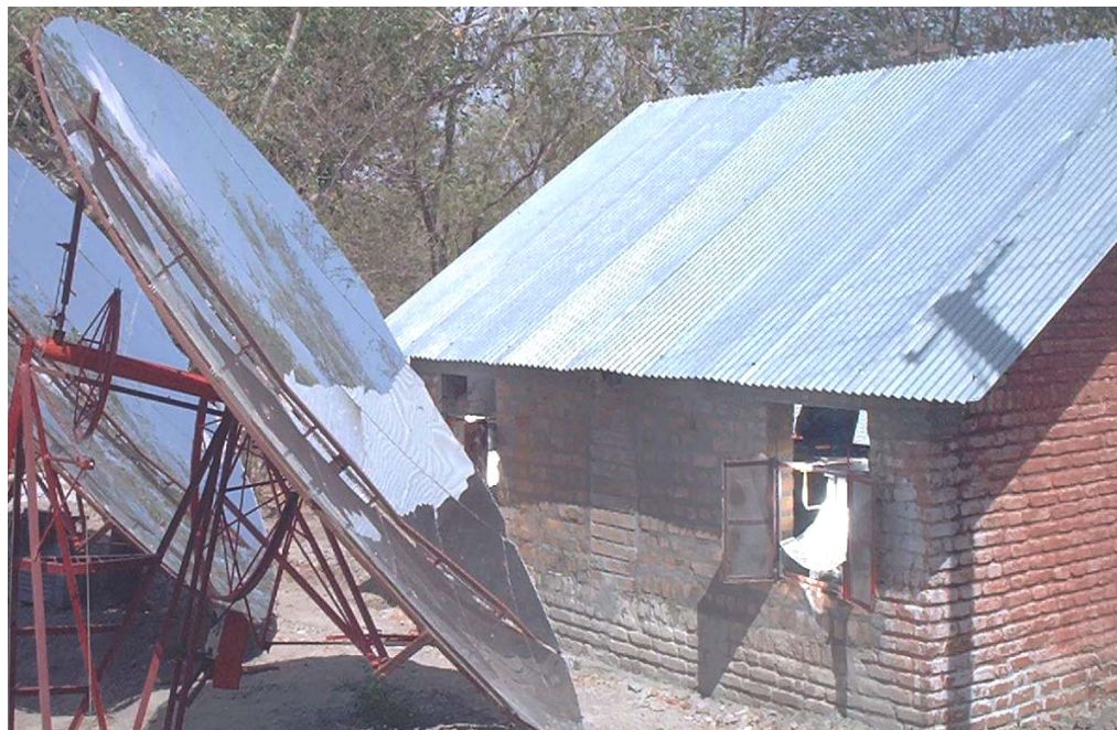
Figura 7.- Foto de un concentrador solar Scheffler (Fuente: Scheffler, 2006).
