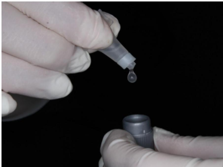
**Figura 6 Preparación de Biodentine.** Se agregaron 5 gotas a la cápsula de Biodentine® (Septodont, Saint-Maur-des-Fossés, France).
