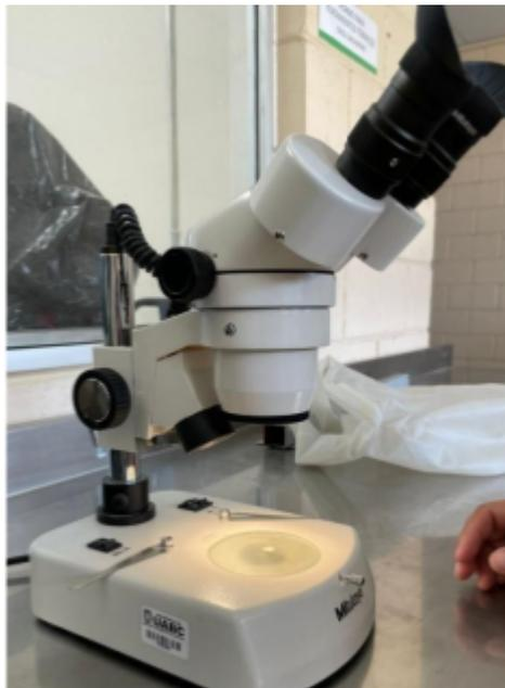
**Figura 27. Observación bajo microscopia.** Estereomicroscopio marca Mitutoyo © (Sakado, Japón) MSM-414L Series 377, Binocular-377 972A.
