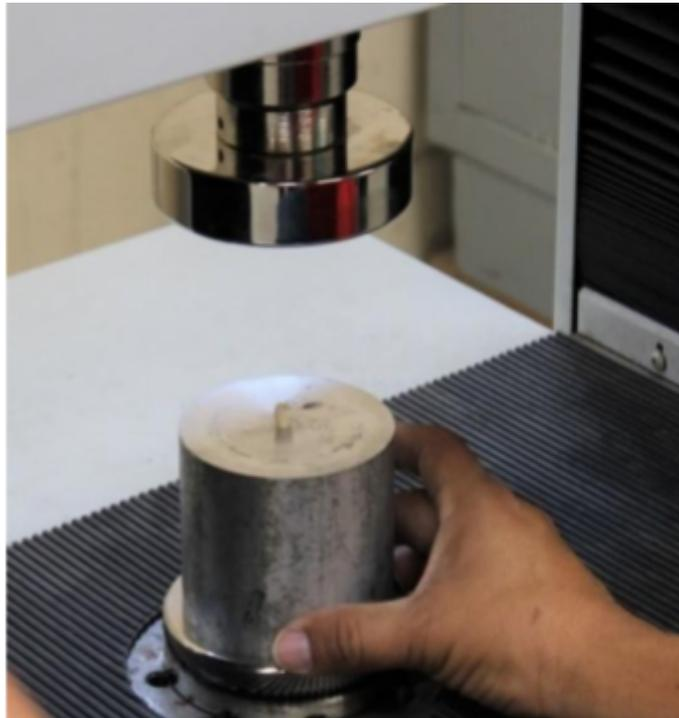
**Figura 25 Máquina universal de ensayos.** Colocación de espécimen en máquina universal de ensayos (Shimadzu Corporation©)
