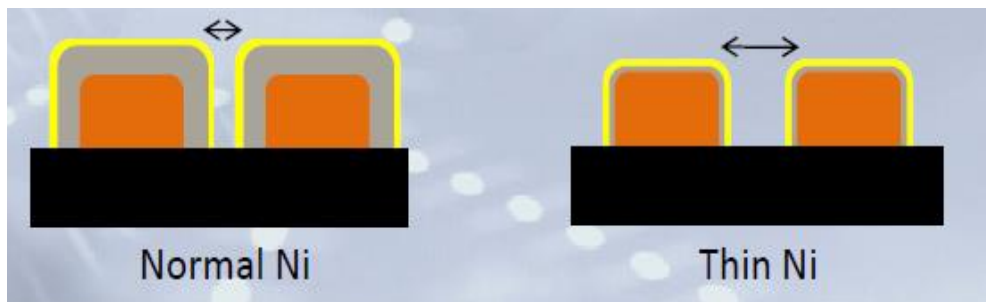
a) Estructura tablero PCB ENEPIG
