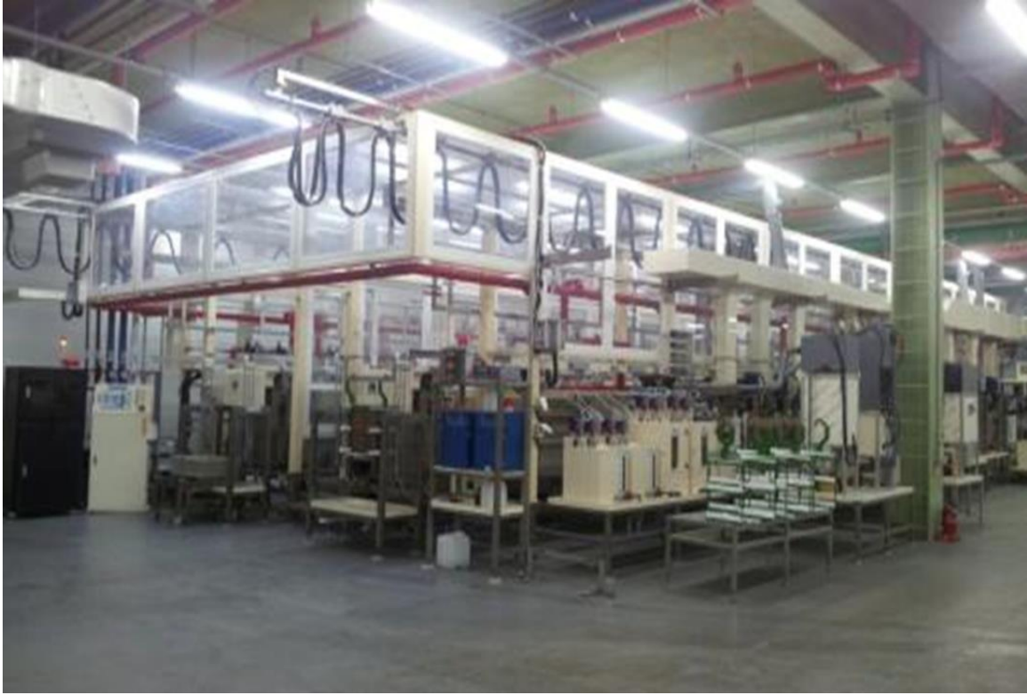
Figura 10: Línea de producción de proceso de tableros ENEPIG.
