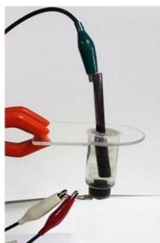
Figura 21. Montaje para electrodeposición
