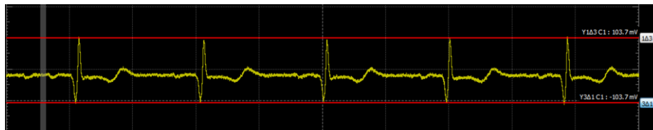
Figura 5.18. Señal ECG con circuito para aplicación cerca del pecho ( Analog Discovery ).
