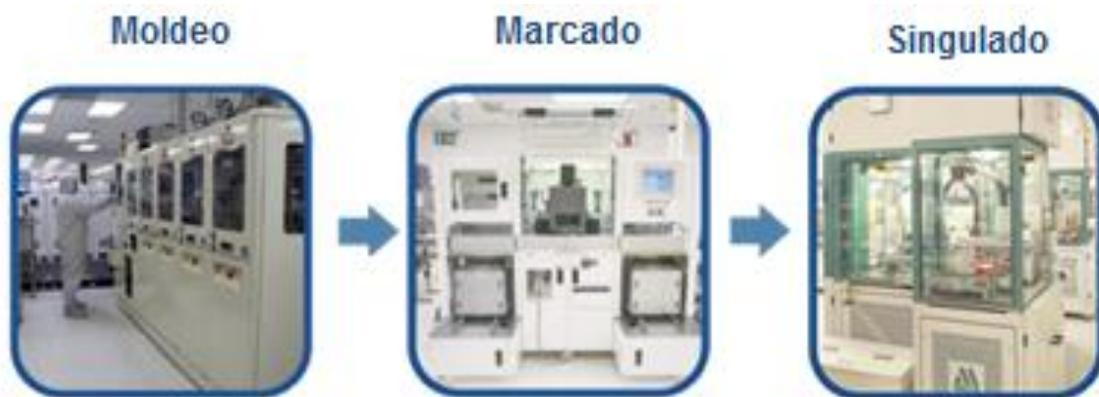
Figura 2.10. Segundo proceso de ensamblado de circuitos integrados de una empresa de semiconductores
