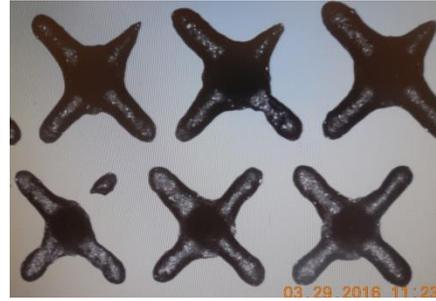
Figura 5.3. Pruebas de patrones de huella de epoxy conductivo
