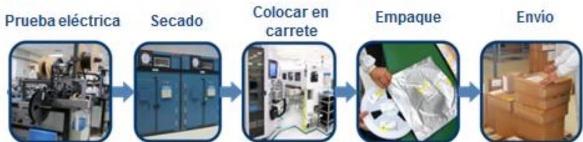
Figura 2.11. Tercer proceso de ensamblaje de circuitos integrados, prueba eléctrica
