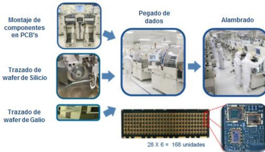
Figura 2.9. Primer proceso de ensamblaje de circuitos integrados de una empresa de semiconductores
