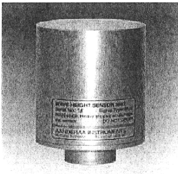
Figura 3.16: Foto del sensor de oleaje modelo 3595 de la compañía Aanderaa.
