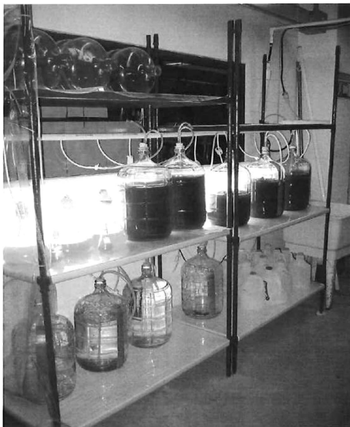
Figura 2.- Sistema utilizado para el cultivo de N. oculata , a partir de inóculos sucesivos en vasos Erlenmeyer, Fernbach hasta garrafones de 18L.
