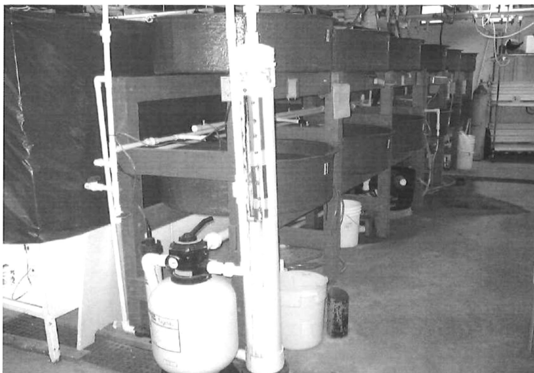
Figura 4.- Sistema de cultivo utilizado para el efecto de la iluminación en el fondo mostrando el filtro de lecho fluidizante, filtro de arena y filtro UV.
