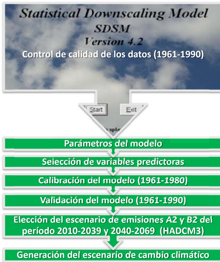
Figura 5.4 Diagrama de flujo general para generar escenarios de cambio climático mediante el SDSM
