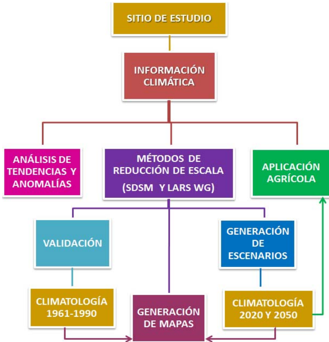
Figura 5.1 Diagrama de flujo general para generar escenarios de cambio climático mediante dos técnicas de reducción de escala y su aplicación al cultivo del trigo
