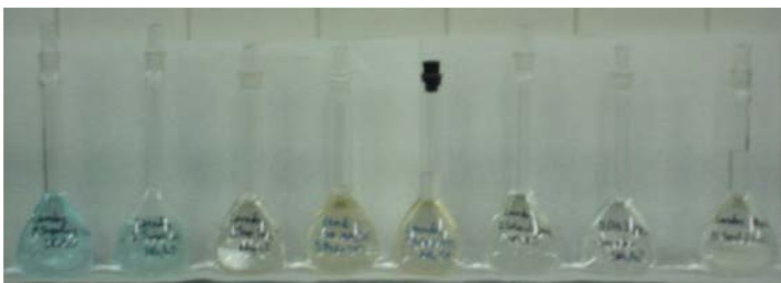
---Fig.9--- Lavados Fase 3 ( \text{NH}_4\text{CH}_3\text{COO} 1N) para determinar C.I.C.
