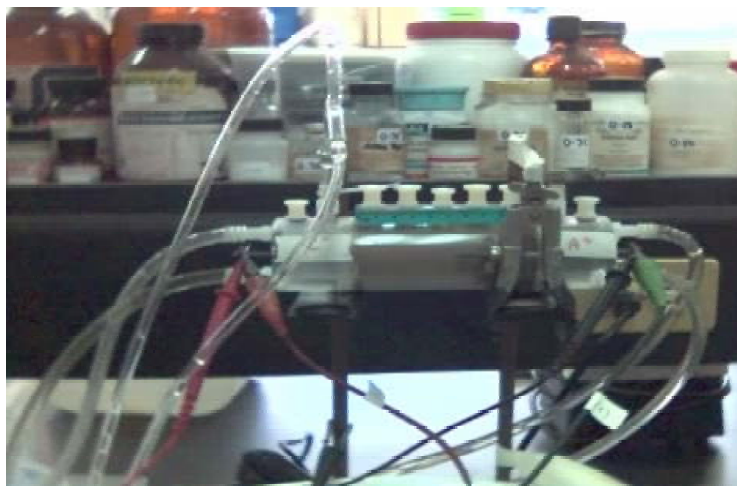
---Fig. 12--- Celda OSMIC I lista para correr tratamiento electrocinética a muestra de suelo.
