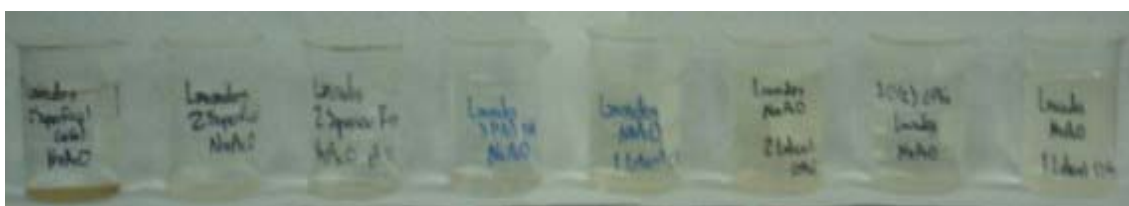
--Fig.7-- Lavados Fase 1 ( \text{NaCH}_3\text{COO} 1N) para determinar C.I.C.
