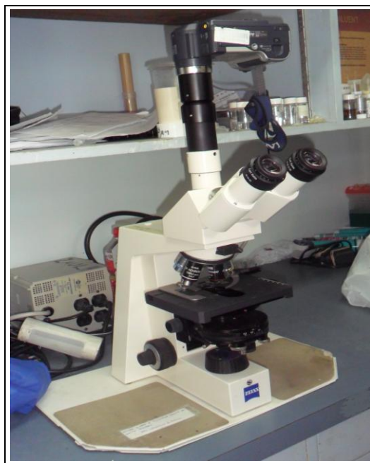
Fig. 3. Microscopio compuesto Zeiss Axiolab con cámara Sony Handycam montada en un tubo especial para el microscopio con el que se procesaron las muestras del experimento.
