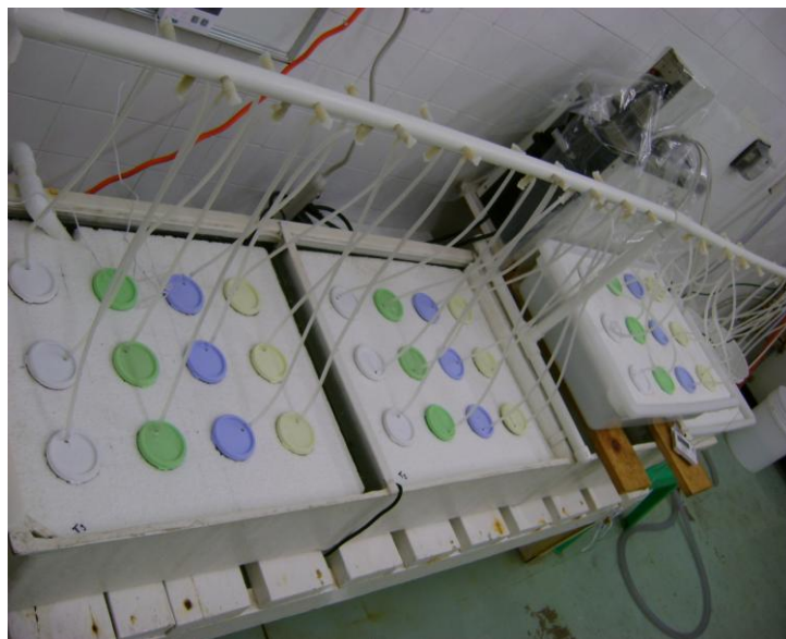
Fig. 4. Sistema de vasos plásticos con tapa donde se mantuvieron las larvas de P. generosa en salinidades y temperaturas.
