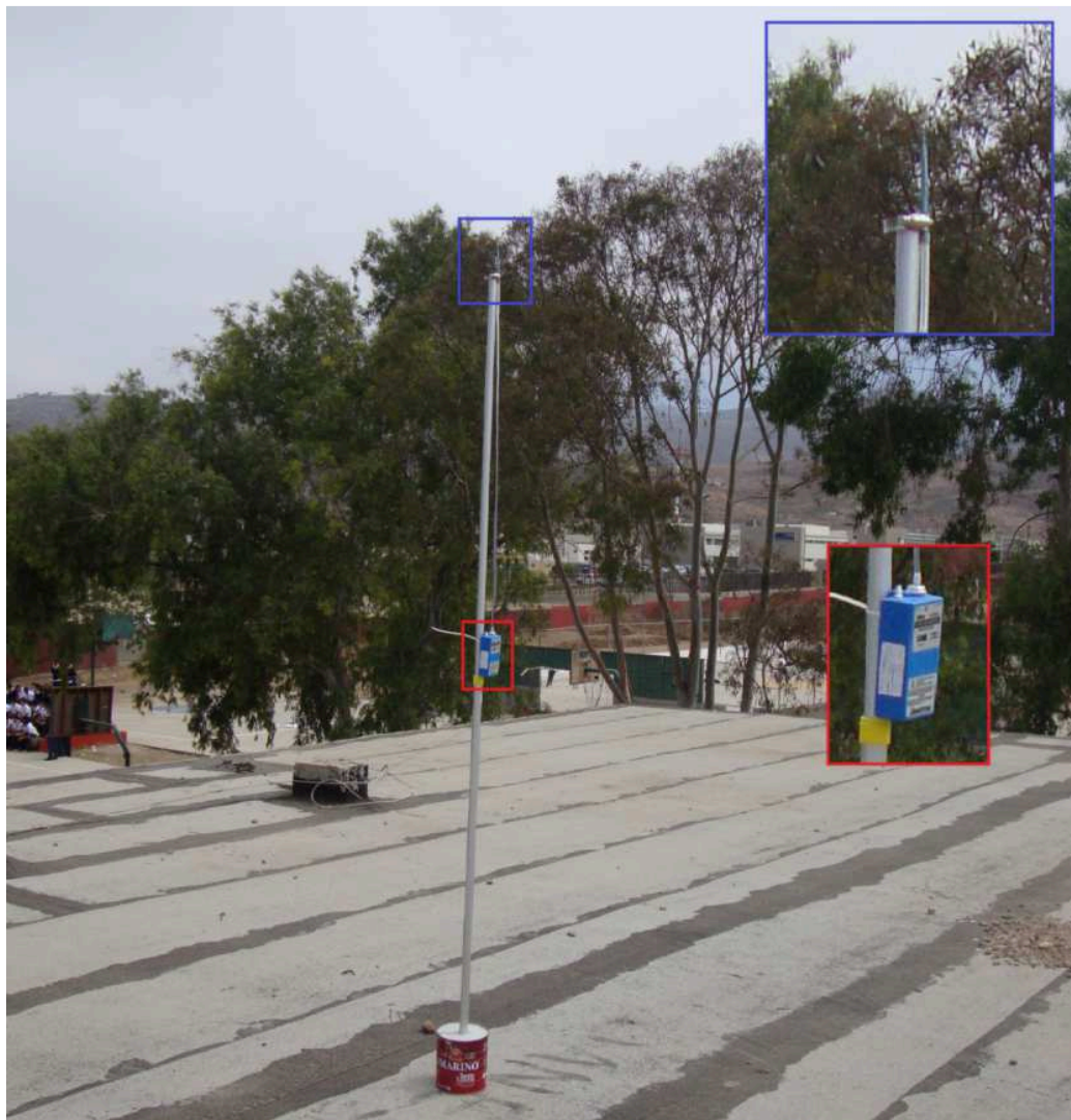
Figura 3. Estación de colecta de muestras de aire. Cuenta con un tubo de desorción en la parte superior de la estructura (recuadro azul) y un muestreador de aire portátil (recuadro rojo).
