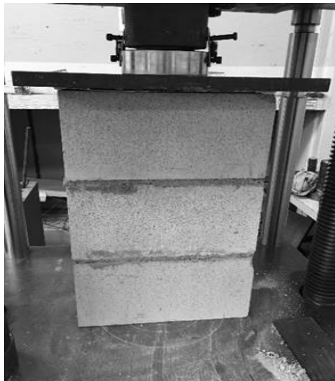
Figura 6.6. Aplicación de carga axial a muestras C1 - Fuente: elaboración propia.
