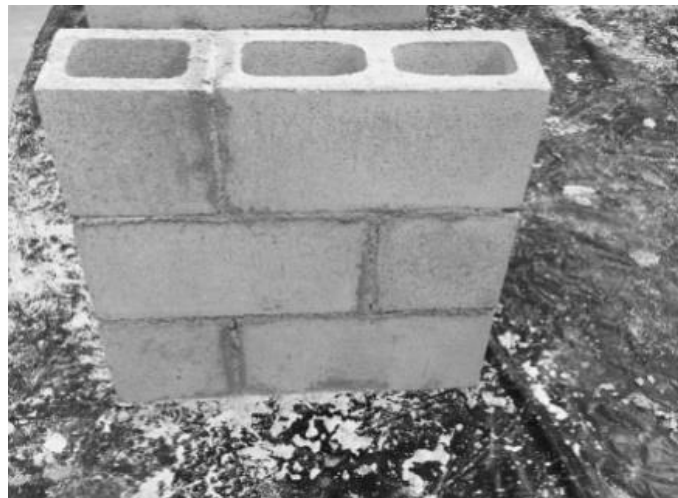
Figura 6.4. Muros de mampostería no reforzados para pruebas de compresión diagonal - Fuente: elaboración propia.
