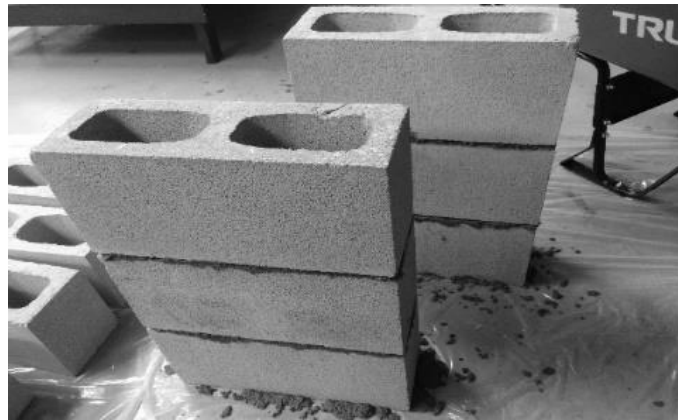
Figura 6.3. Muros de mampostería no reforzados para pruebas de compresión - Fuente: elaboración propia.
