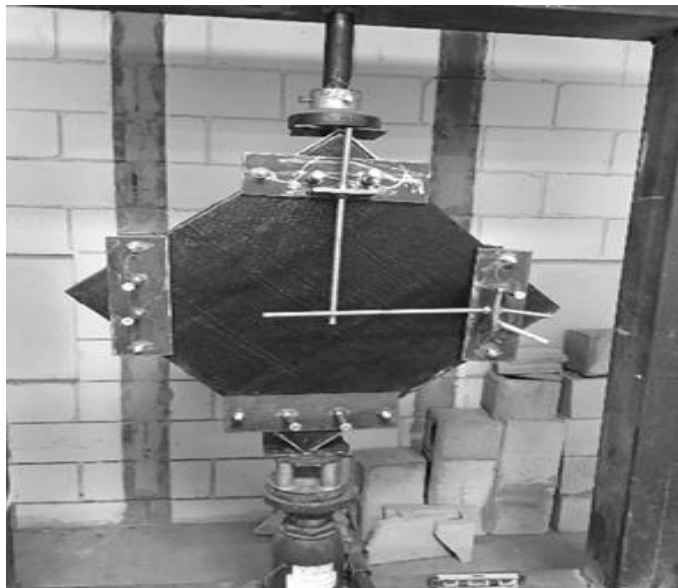
Figura 6.8. Aplicación de la carga diagonal a especímenes reforzados S2 - Fuente: elaboración propia.
