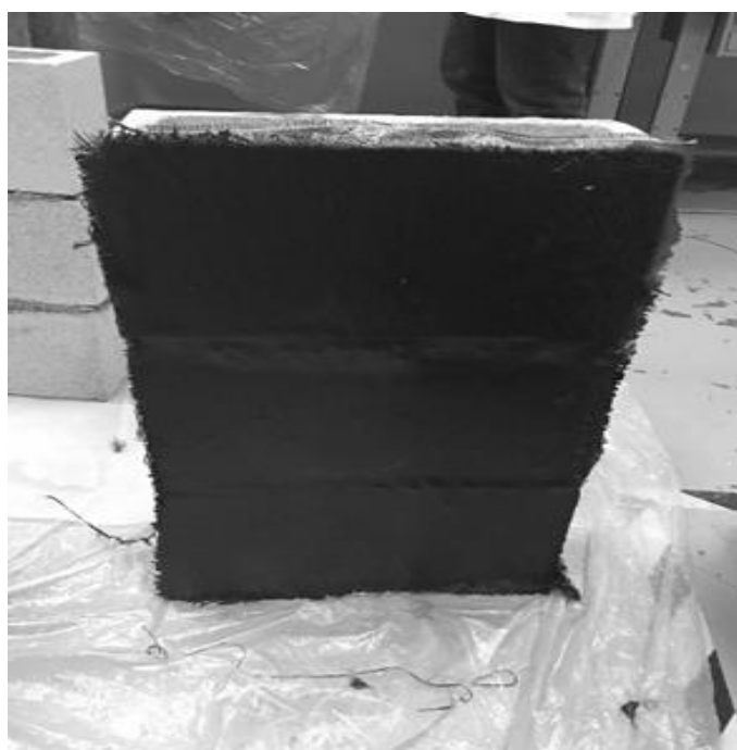
Figura 6.5. Muros de mampostería reforzada para ensayos de compresión - Fuente: elaboración propia.
