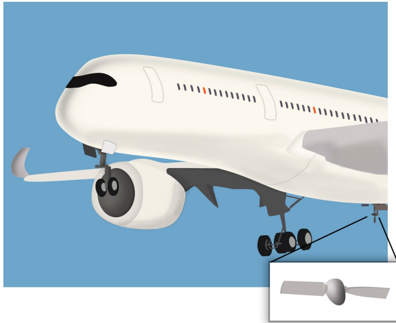
Figura 1.1: Ubicación de la turbina de emergencia RAT.
