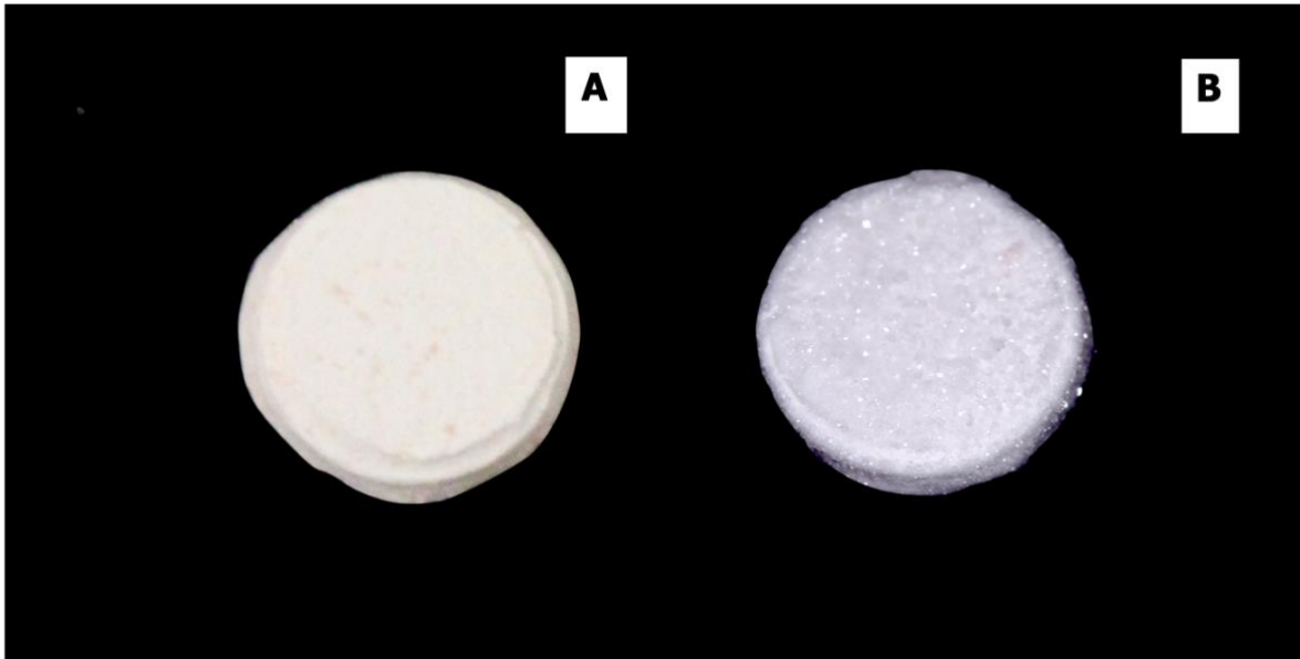
Figura 12. Formación de cristales en las pastillas de cemento CeraSeal en agua destilada
